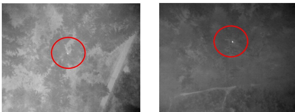
Abbildung 9 Die an der Drohne befestigte Wärmebildkamera zeigt eine Wärmequelle auf (weiße Flecken in der roten Markierung). Anhand dieser Bilder entscheidet der Pilot, ob die Wärmequelle die Position eines Hundes bzw. Versuchsperson markiert oder nur die einer Störquelle. Bei Unsicherheiten war es zulässig, die Flughöhe der Drohne zu minimieren. © FAWF Landesforsten RLP
