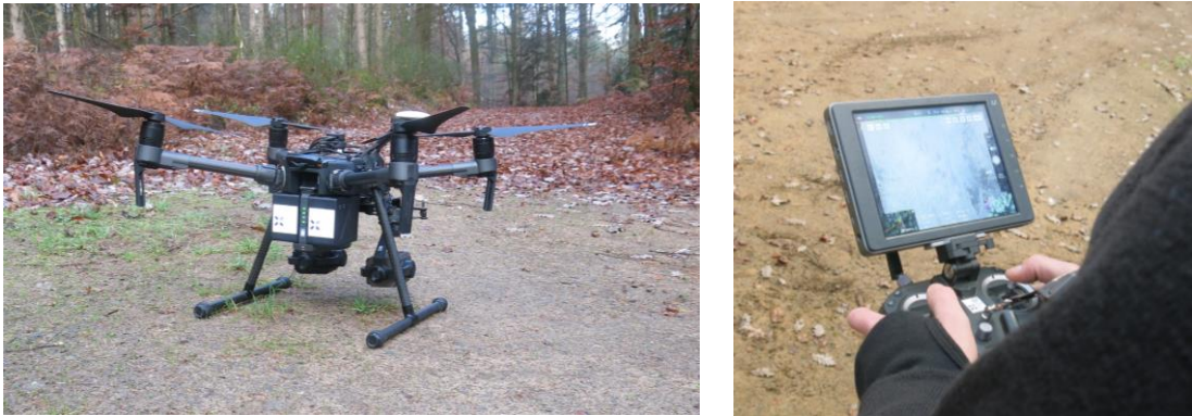
Abbildung 1 Die Drohne DJI Matrice 210 wurde grundsätzlich für die Befliegungen in diesem Projekt genutzt. Hier im Bild (links) ist die Drohne mit einer Wärmebildkamera DJI Zenmuse XT 13 mm und einer RGB-Kamera DJI Zenmuse Z30 mit einem CMOS 1 / 2.8 – Sensor ausgestattet. Im rechten Bild ist der zugehörige Controller der Drohne abgebildet. © FAWF Landesforsten RLP
