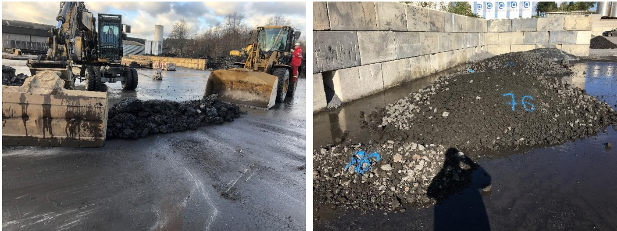
Abb. 23: Rohschlacke vor der Aufbereitung, separiert nach Chargen
