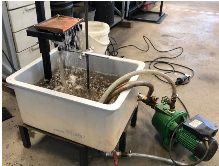
Abb. 19: Versuchsaufbau, wassergekühlte Kupferplatte
