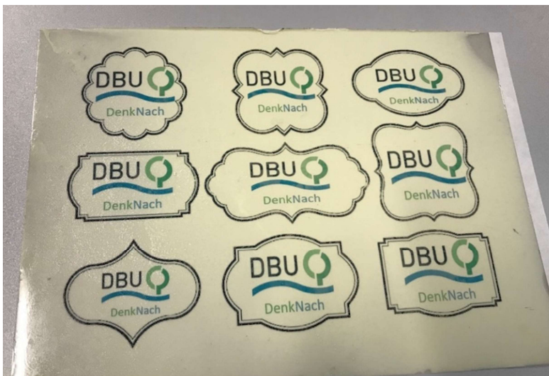
Abb. 4.3-2: mit einem herkömmlichen Tintenstrahldrucker bedruckte Gummibärchen-Folie auf einer Träger-Folie
