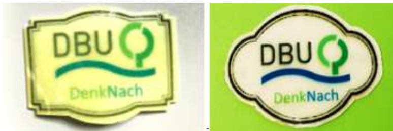
Abb. 5.3-6: Etiketten nach dem Bedrucken und nach dem Beschichten mit gelben Gummibärchen (links) bzw. mit weißen Gummibärchen (rechts)
