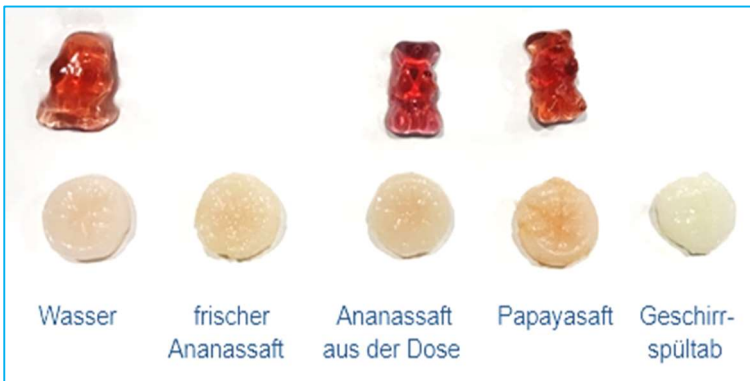
Abb. 5.2-3: Gelatinehaltige Gummibärchen (obere Reihe) im Vergleich zu stärkehaltigen Gummibärchen (untere Reihe) nach Einwirkung unterschiedlicher Enzymlösungen
