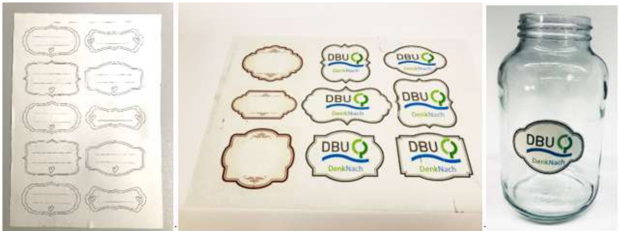
Abb. 5.3-8: Auf eine Gummibärchen-Folie mit einem Lebensmitteldrucker bedruckte Etiketten (links und Mitte) und ein solches Etikett nach dem Ausschneiden und Aufkleben auf ein Glas (rechts)
