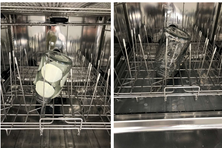
Abb. 5.3-13: Ein mit Gelatine-Etiketten beklebtes Glas in einer Spülmaschine (links) und das Etiketten-freie Glas nach 10 min Spülgang bei 55 °C (rechts)
