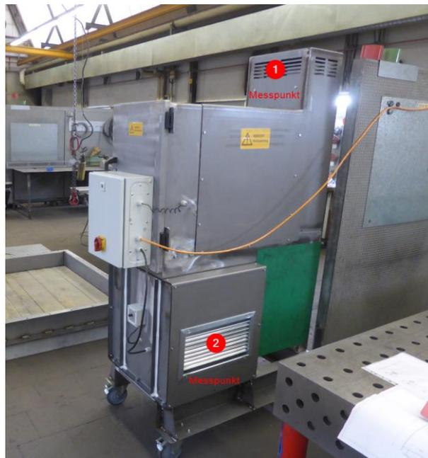
Abbildung 15: Aufstellungssituation des E-Abscheider-Prüfstands
