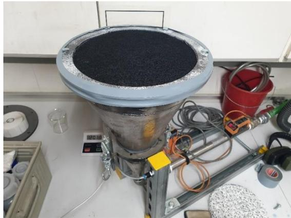
*Abbildung 30: Druckverlustmessung der Aktivkohlefiltermatte*
