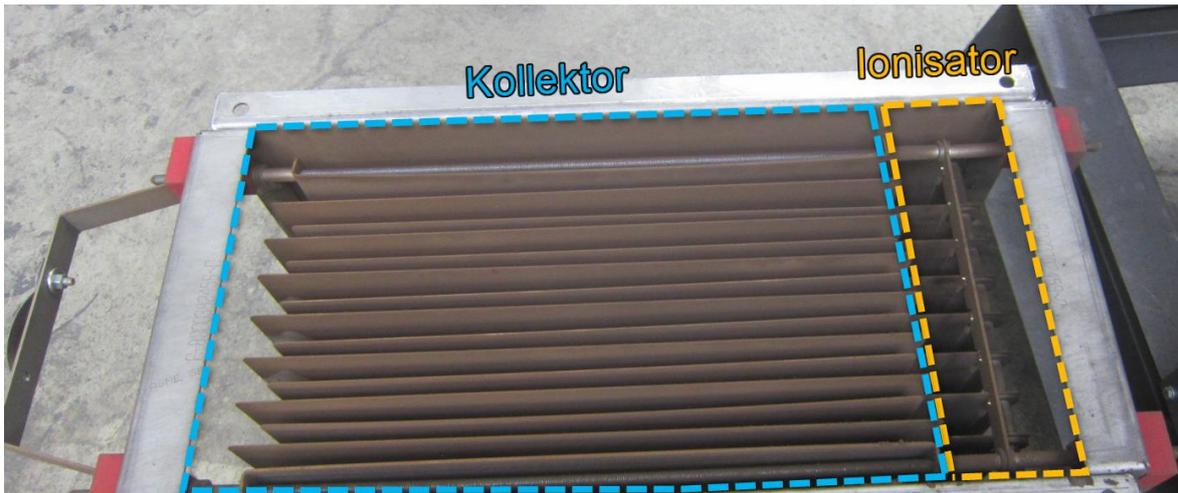
Abbildung 20: Gleichmäßige Beschichtung von Ionisator und Kollektor durch Partikel
