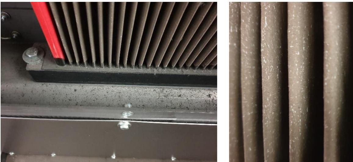
Abbildung 25: Abgeschiedene Aerosole auf Filterelement
