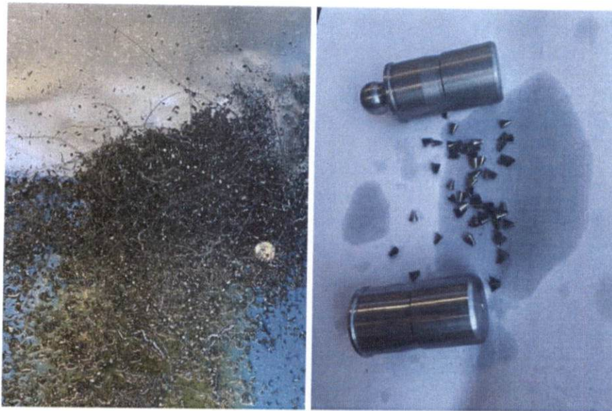
Abbildung 17: Blick in den Spänecontainer (links), kurzbrüchige Späne vom Vorbohren (rechts)
