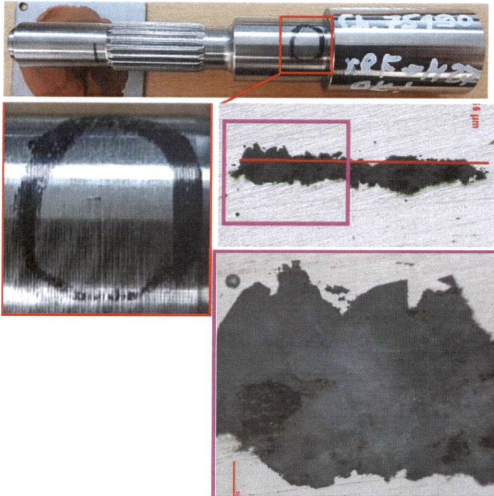
Abbildung 11: 2,98 mm langer Makro-Einschluss der Charge 38MnVS6 - 75190, Store Steel
