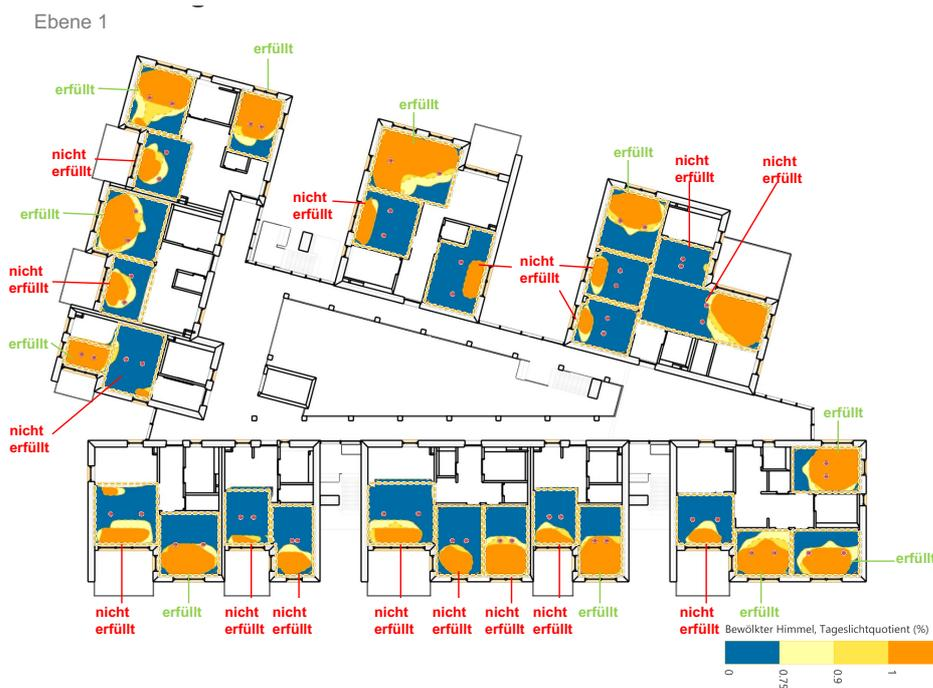
Abbildung 36: Ergebnis Tageslichtquotient - Ausgangssituation
