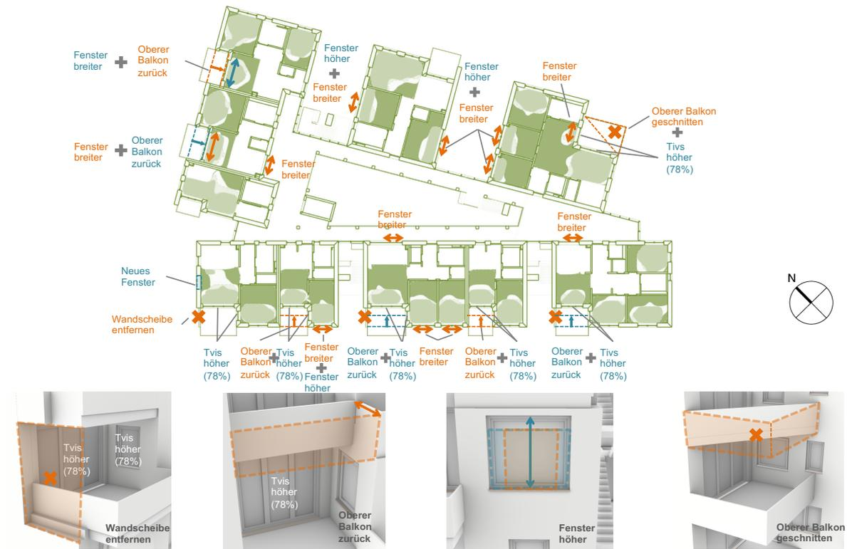
Abbildung 40: Verbesserungsvarianten 2. Stufe
