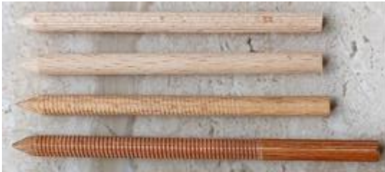
Abb. 19: Oberflächenstrukturierung von Nägeln. Unten Lignoloc und oben 3 Buchennägel. Die beiden unteren Nägel mit Gewinden mit Stegbreiten von 1 mm und Ganghöhen von 1 mm. Ganz oben Buchennagel mit Längsriffelung, darunter Buchennagel ohne Strukturierung.
