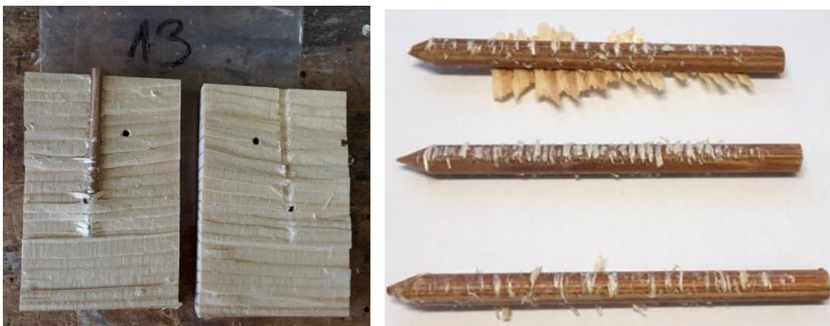
Abb. 5: Zwischenschritt der Probenpräparation: Links: Aufgespaltenes Kantholz mit innenliegendem Lignoloc-Nagel. Rechts: Nägel mit Spananhaftungen
