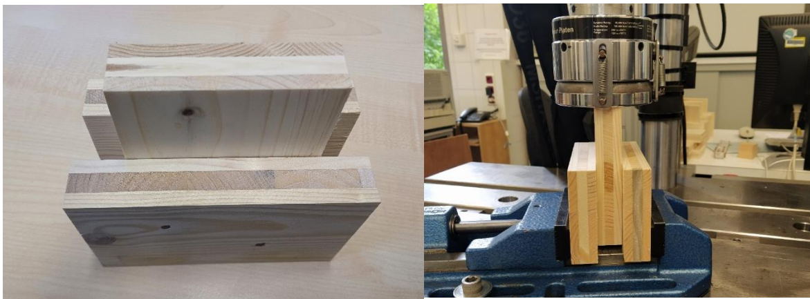
Abb. 3: Probe für Prüfung der dynamischen Festigkeit mit Lignoloc-Nägeln (links). Prüfaufbau in Prüfmaschine (rechts)
