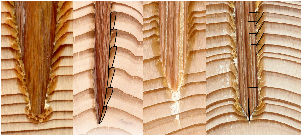
Abb. 53: Verschiedene Lignoloc Nagelspitzen mit umgebender verdichteter Holzmatrix (Fichtenholz).
