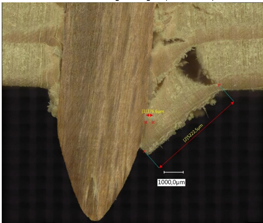
Abb. 52: Nagelspitze mit ausgebrochenem Matrixmaterial an der Nagelaustrittsstelle.
