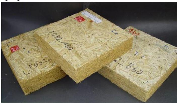
Abbildung 8: Dämmstoffplatten aus Typha
