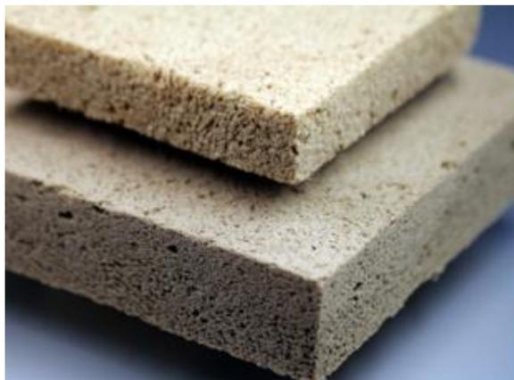
**Abbildung 2: Holzschäume unterschiedlicher Dichte**
