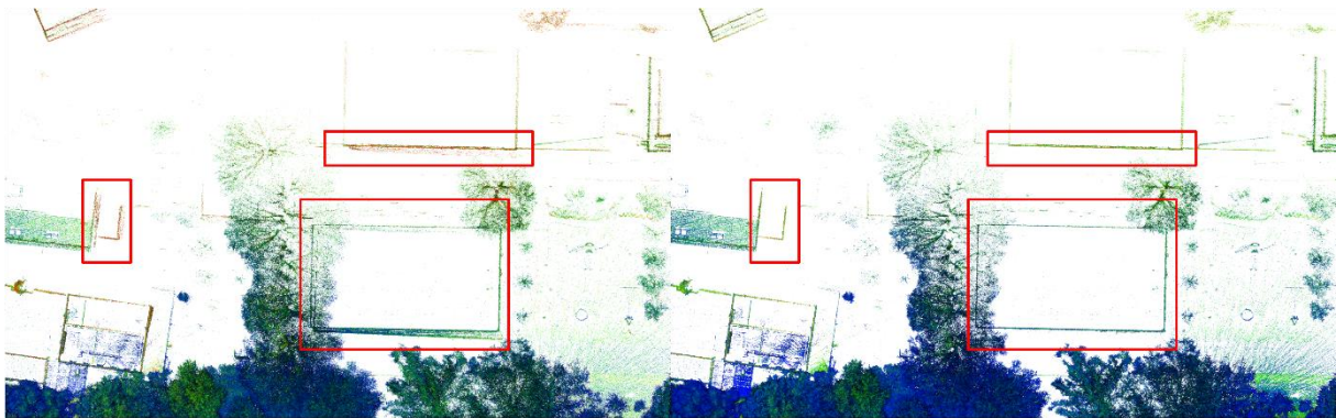
Abbildung 33: Systematische Abweichungen in der Punktwolke verursacht durch eine ungünstige Führung der mobilen Messplattform (links) im Vergleich zur, mittels Passpunktinformationen, reprozessierten Punktwolke (rechts).
