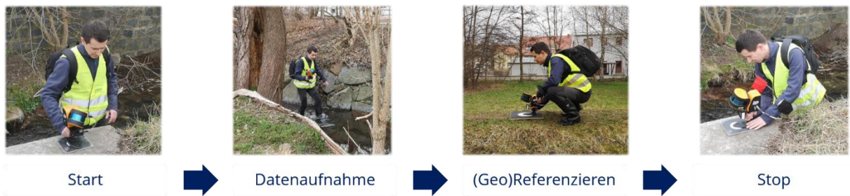
Abbildung 10: Vereinfachter Ablauf der Messung mit dem ZEB Horizon aufgeteilt in die Hauptschritte. Starten der Messung mittels 17 sekündigem Aufhalten auf dem Startpunkt (links), gefolgt von der Datenaufnahme (2 Bild v.l.), dem min. 10 sekündigen Aufhalten der Passpunkte zur Georeferenzierung (3 Bild v.l.) und dem Beenden der Messung mittels Aufhalten auf dem Startpunkt (ganz rechts)
