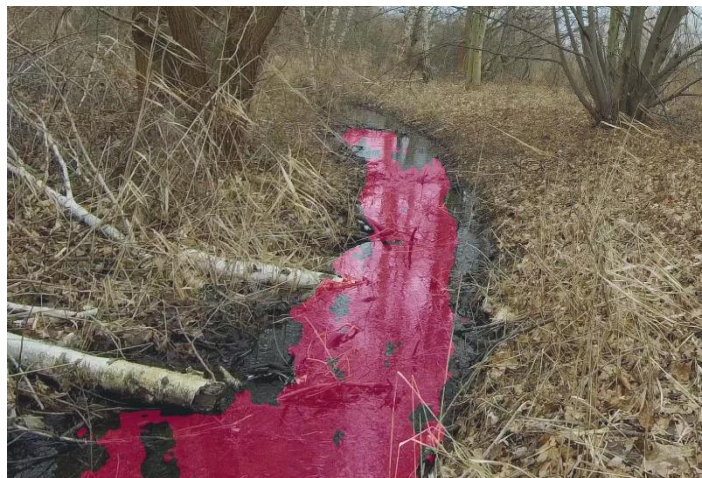
Abbildung 24: Test von CNNs zur Gewässerflächensegmentierung. Das Beispiel zeigt exemplarisch das Ergebnis eines Segmentierungsversuchs unter Nutzung von U-Net mit ResNext50 als Backbone. Häufig wurden die Gewässerflächen lückenhaft segmentiert, so dass eine Weiternutzung zur Uferliniendetektion nicht möglich war.
