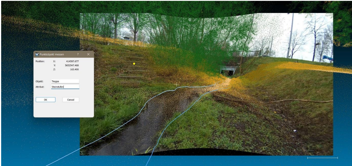
Abbildung 23: Messung von Punktobjekten. Blick auf die Laserscannerpunktwolke aus Sicht einer Kameraposition im 3D-Viewer. Zur Identifizierung von Objekten wird die Bildinformation der Kameraaufnahme eingeblendet. Die Messung erfolgt in der Punktwolke (gelbe Punktmarkierung). Im Dialogfeld können Objektbezeichnung und Attribute angegeben werden.
