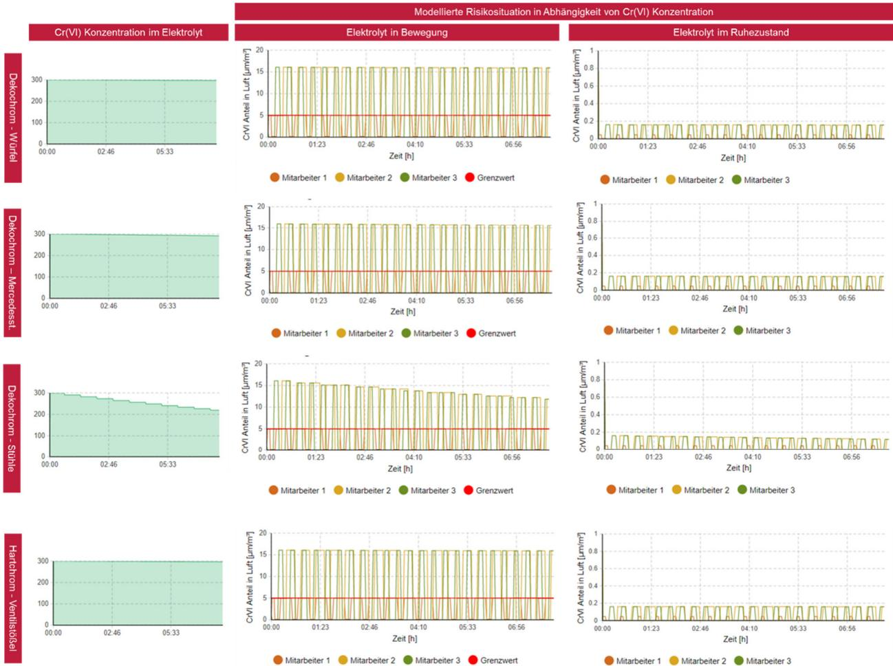
Abbildung 25: Entwicklung der modellierten Cr(VI) Konzentration im Elektrolyten und der Mitarbeiterbelastung bei verschiedenen Bauteilen und Fluidgeschwindigkeiten
