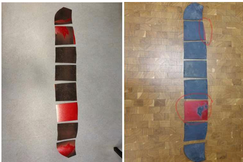
Abbildung 37: Vorderseite Bauteil vor (links) und nach (rechts) dem Strahlen
