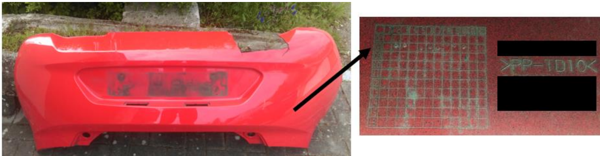
Abbildung 18: Stoßstange aus Polypropylen (PP) (links) Herstellungs- und Materialinformationen (rechts).
