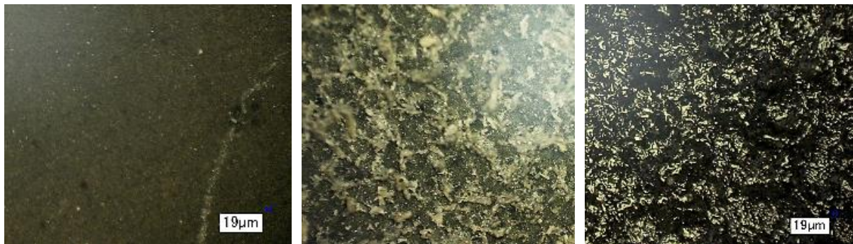
Abbildung 31: Oberflächen der laserbearbeiteten Bauteile (Trägermaterial ABS) (links: unbeschädigt, mitte: leicht beschädigt, rechts: beschädigt)
