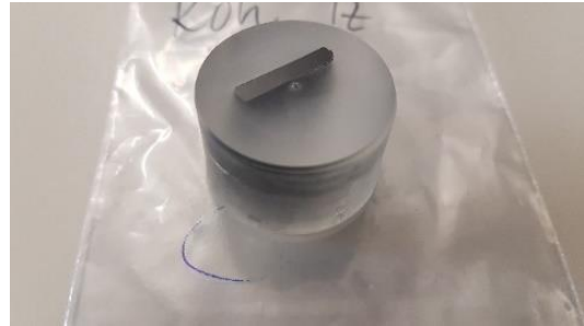
Abbildung 11: Probe in Harz eingebettet
