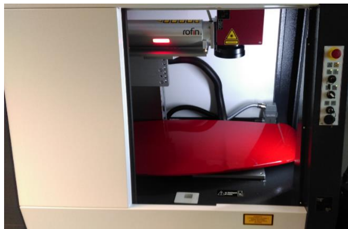
Abbildung 19: 50 Watt Faserlaser der Fa. Coherent/Rofin
