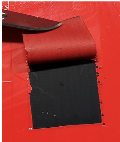
Abbildung 22: Laserbearbeitung einer 20 mm x 20 mm großen Oberfläche mit Farbabtrag.
