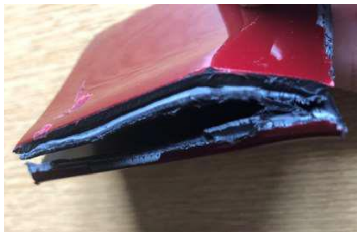
Abbildung 17: Trennung von dreidimensionalen Bauteilen mit der Abschlagschere
