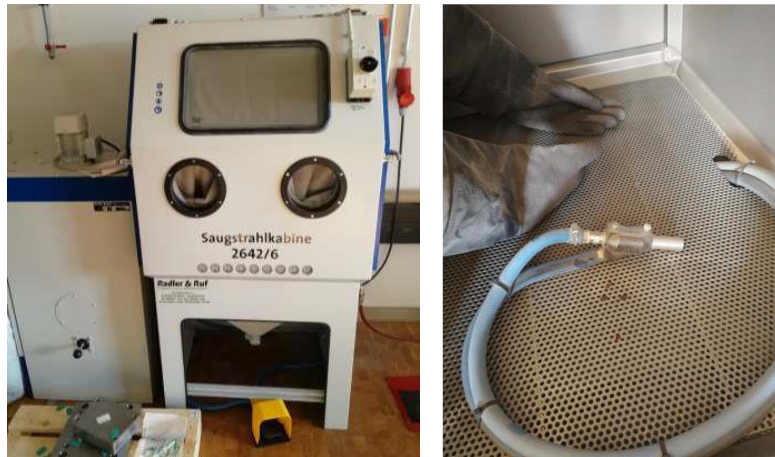
Abbildung 36: Saugstrahlkabine (links: Außenansicht; rechts: Innenansicht)
