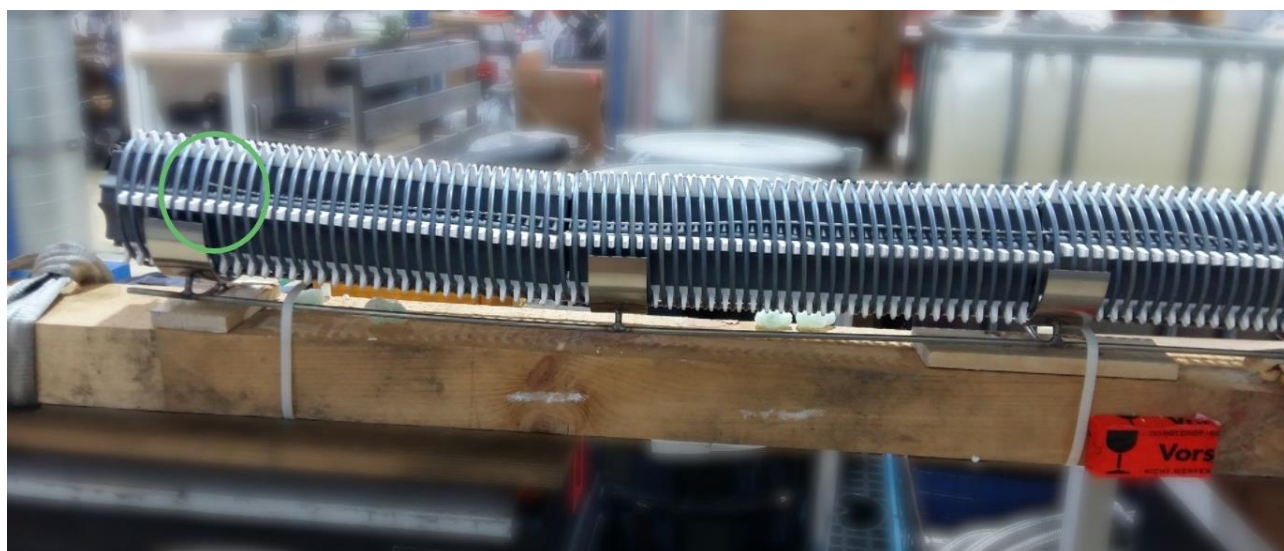
Abbildung 17: Positionierung der Temperaturmessstelle T3 auf dem Hybridflammrohr
