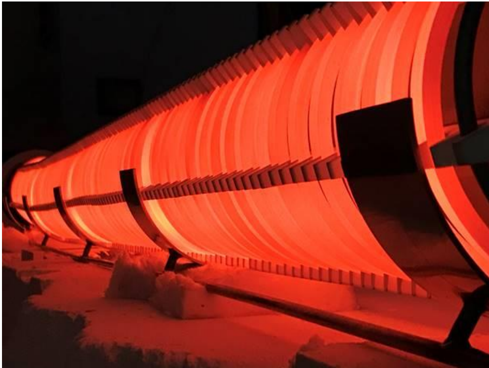
Abbildung 11: Fotografische Ansicht des Funktionstests der elektrischen Beheizung
