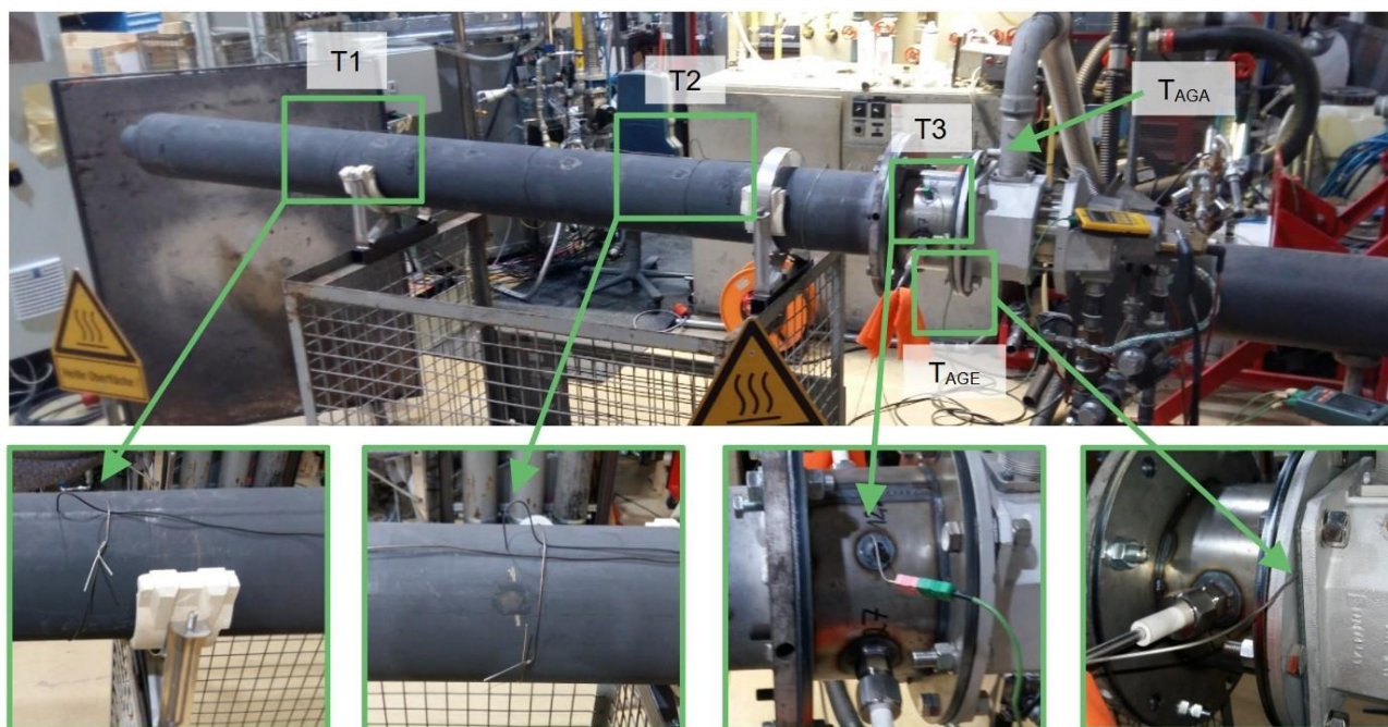
Abbildung 16: Fotografien der Temperaturmessstellen am Hybridstrahlrohr
