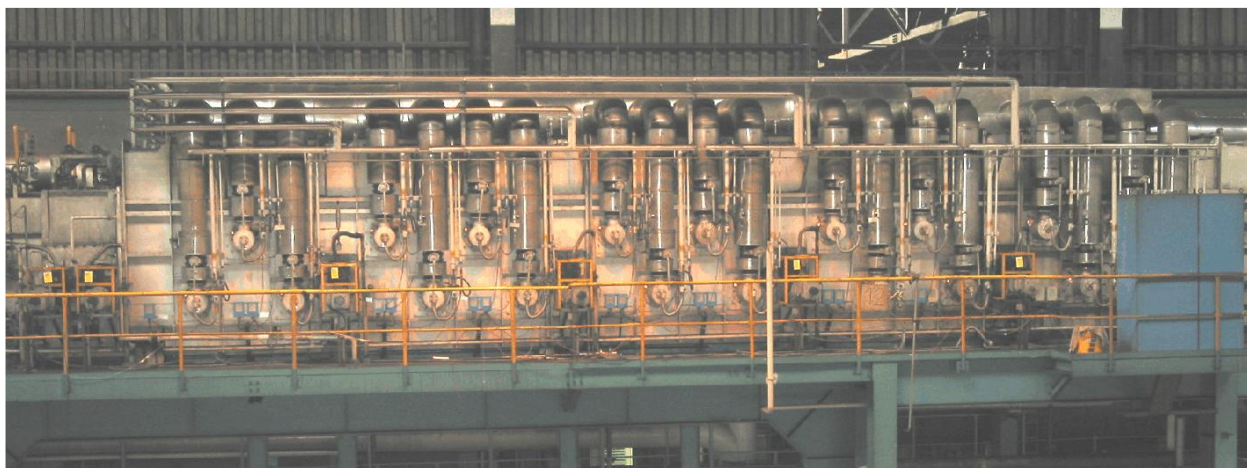
Abbildung 1: Beispielhafte Darstellung eines Banddurchlaufofens
