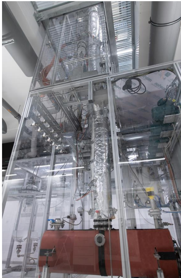
Abbildung 6) Unterer Teil der realen Anlage, das rot-isolierte Bauteil ist der Verdampfer.
