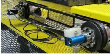
mit querkraftunempfindlichen T-Sensoren
