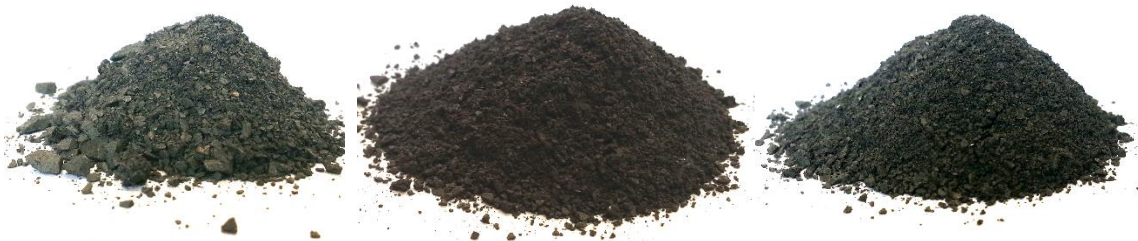
Abbildung 5: Magnetische Pulver nach 10, 15, 30 Sekunden Mahlen
