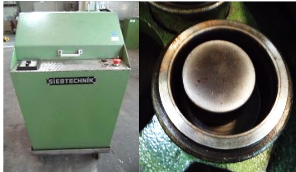
Abbildung 4: Zerkleinerung mit der Scheibenschwingmühle, Siebtechnik
