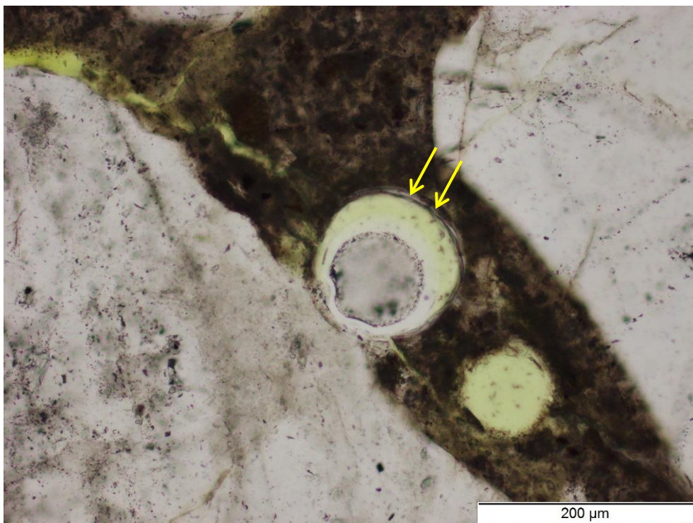
Bild 46 SL05 NF; Dünnschliff nach 60 °C Betonversuch mit Alkalizufuhr (10 %ige NaCl-Lösung); AKR-Produkte in Luftpore (gelbe Pfeile), Aufnahme bei polarisiertem Licht
