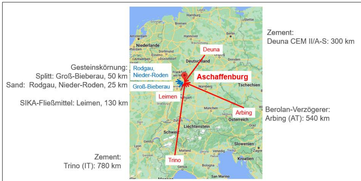
Bild 83 Transportentfernungen für die Betonausgangsstoffe zum Bahnschwellenwerk Aschaffenburg
