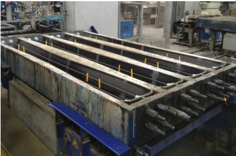
Bild 70: Für das Vorspannen vorbereitete Form
