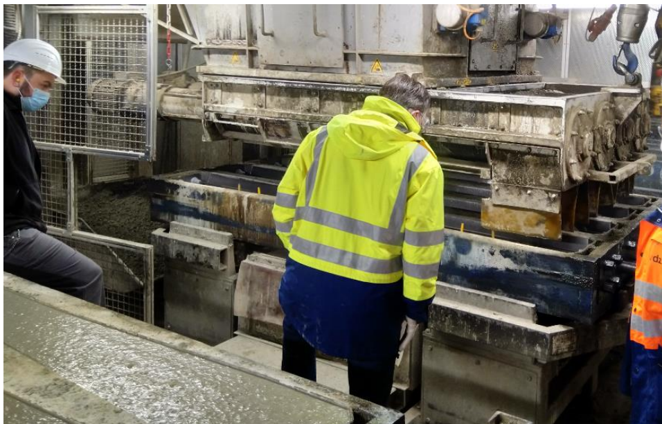
Bild 75: Betonage der zweiten Form mit 4 Betonschwellen
