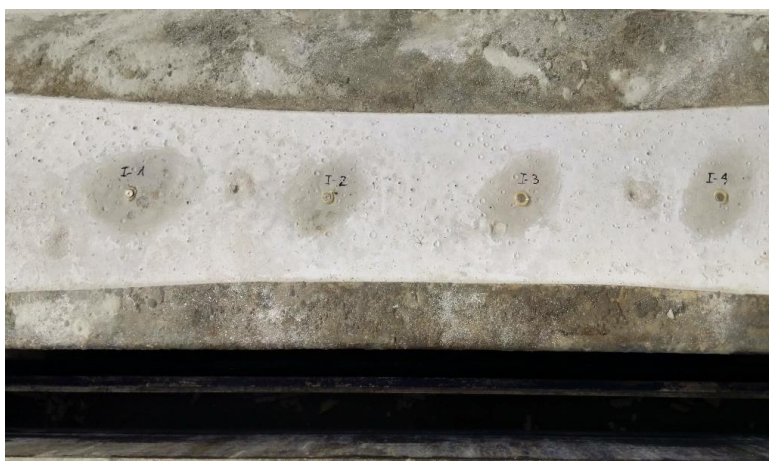
Bild 77: Aufnahme auf die Unterseite der in der Form liegenden Schwelle mit geklebten Messmarken für die Verformungsmessung
