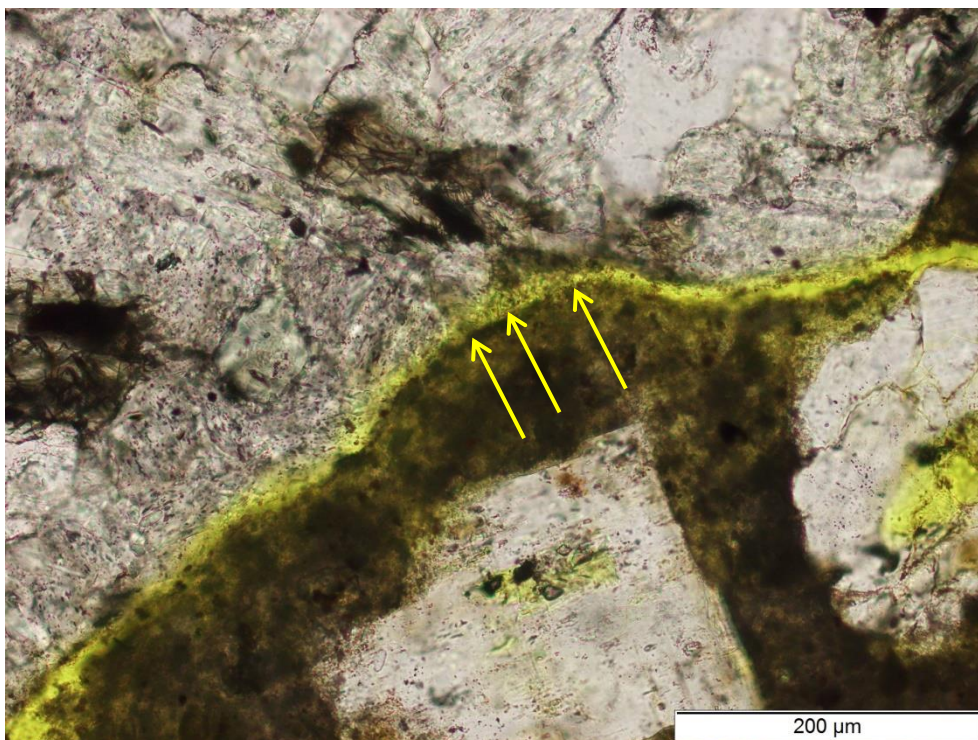
Bild 52 CEM II/A-LL + SR03; Dünnschliff nach 60 °C Betonversuch mit Alkalizufuhr (10 %ige NaCl-Lösung); Riss entlang des Übergangs Zementstein-Gesteinskörnung stellenweise verfüllt mit nadeligen Kristallen aus Ettringit (gelbe Pfeile), Aufnahme bei polarisiertem Licht
