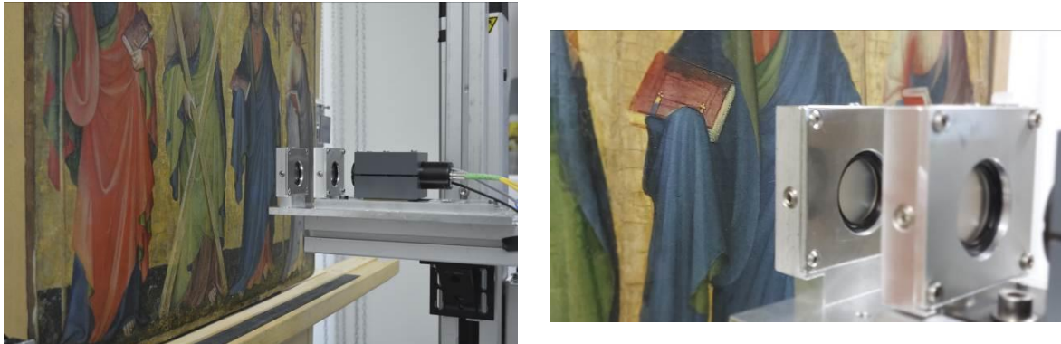
Abb. 39 Der Terahertz-Messkopf bei der Messung am Gemälde.
