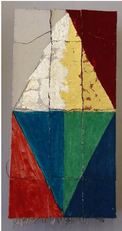
Abb. 32 Aufsicht des Prüfkörpers mit verschiedenen Pigmenten und Blattmetallaufgaben.
