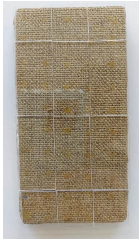
Abb. 30 Probekörper mit textilem Bildträger.
