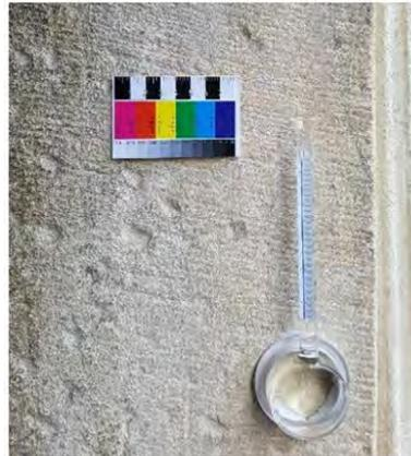
**Abb. 24:** Karstensches Prüfröhrchen mit einem Glockendurchmesser von 45 mm.
