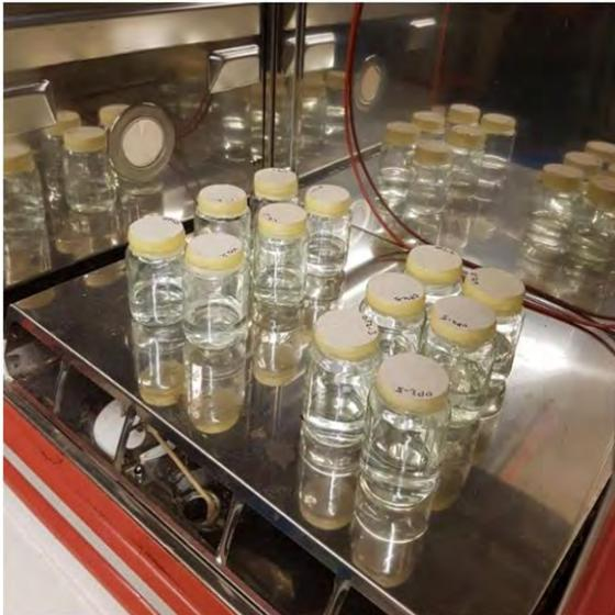
**Abb. 26:** Präparierte Proben zur Ermittlung des  $\mu$ -Wertes (wet-cup) im Klimaschrank.
