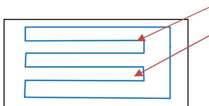
Anordnung der Bohrkanäle
