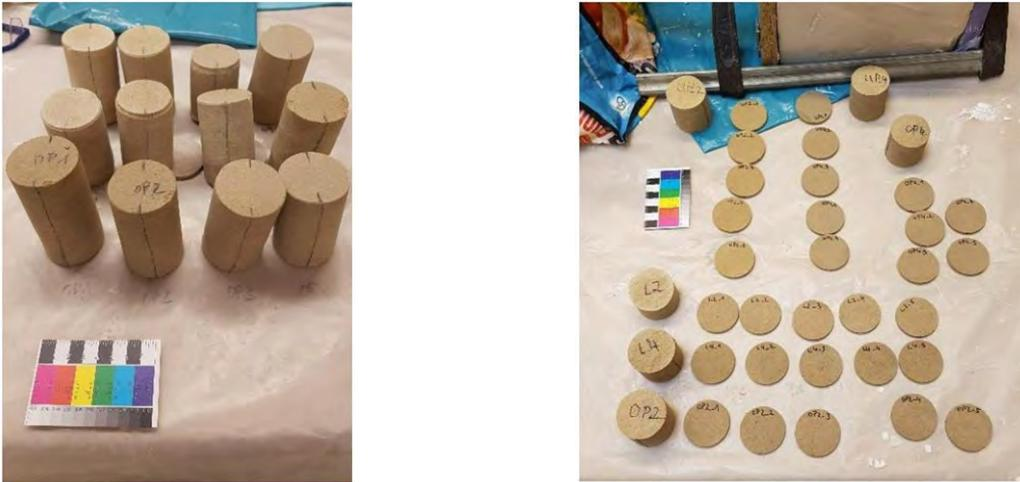
**Abb. 22:** Bohrkern aus den Quadern Oberpaol, Unterpaol und Lappen (links) und jeweils 5 Bohrkernscheiben aus jedem Bohrkern für die Messung der  $\mu$ -Werte und der biaxialen Biegezugfestigkeit/E-Modul.
