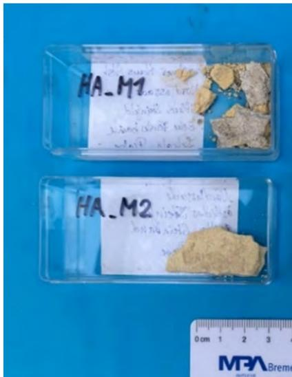
**Abb. 38:** Entnommene Proben für Tropfenaufsetzmethode und Gefügeanalyse
