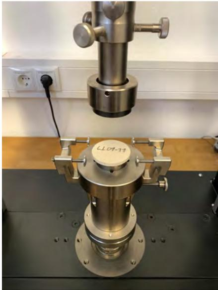
Abb. 111: Vorrichtung zur Durchführung der biaxialen Biegezugfestigkeit.
