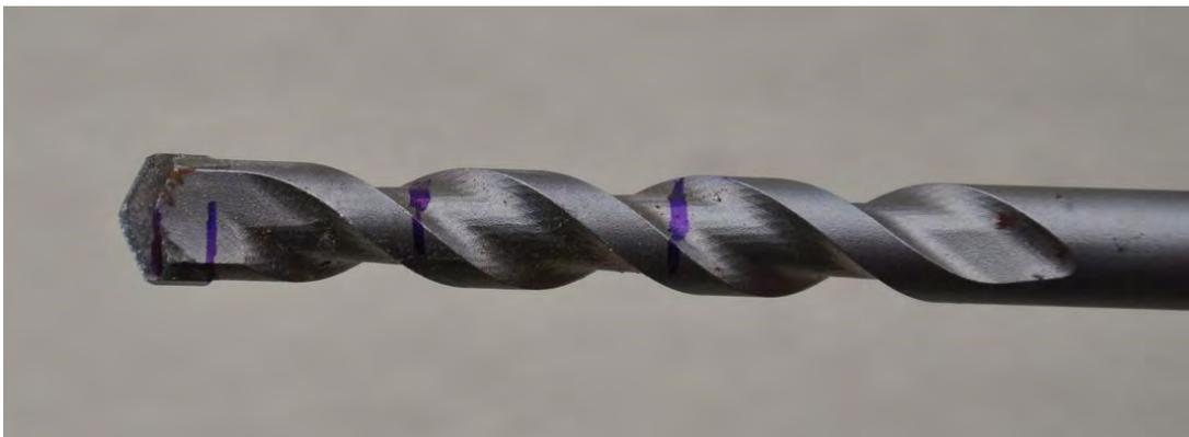
**Abb. 92:** Spiralbohrer (Durchmesser 8 mm) mit markierten Segmenten
