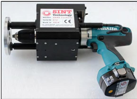
**Abb. 93:** verwendetes Bohrwiderstandsmessgerät
