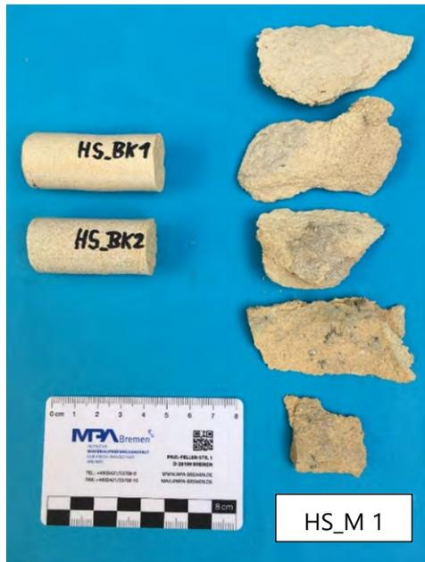
Abb. 55: Entnommene Proben für Tropfenaufsetzmethode und Messung der US-Geschwindigkeit.
