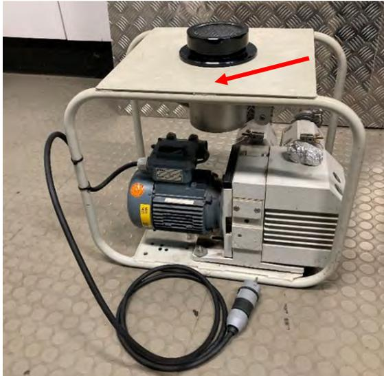
**Abb. 102:** Vakuumpumpstand. Der Pfeil markiert die Probenklammer.
