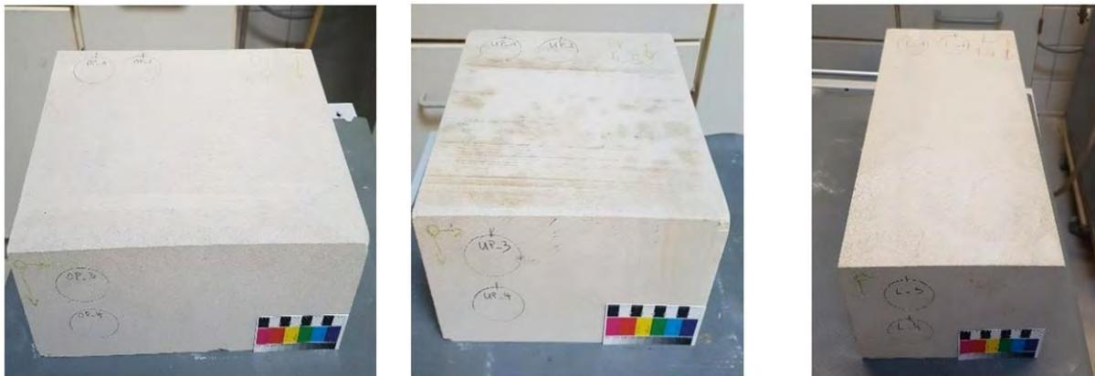
**Abb. 20:** Quader der drei Varietäten des Baumberger Kalksandsteins – Oberpaol (OP), Unterpaol (UP) und Lappen (L). Die Kreise markieren die Stellen, an denen die Bohrkerne für die petrophysikalischen Messungen entnommen worden sind.
