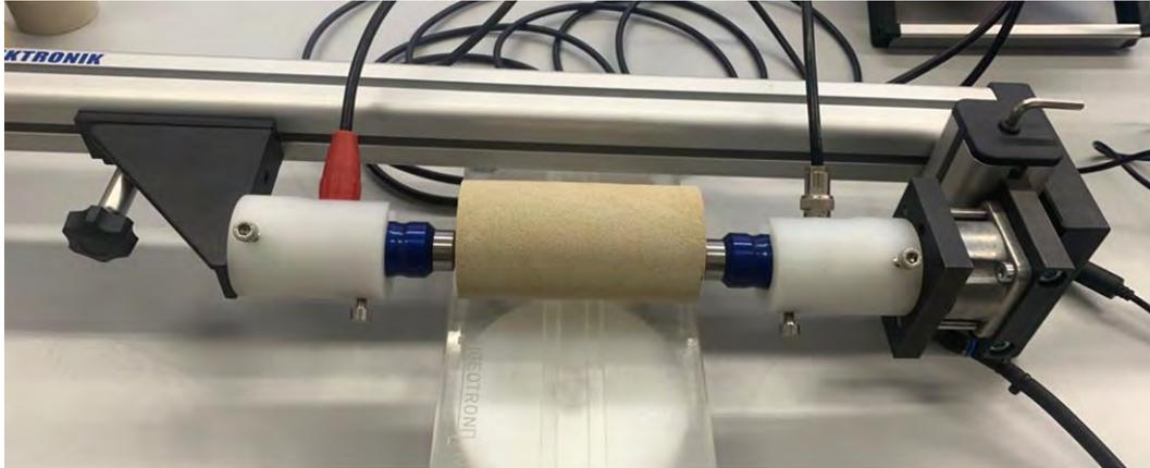
**Abb. 124:** *Eingespannte Probe bei der Ultraschallmessung.*
