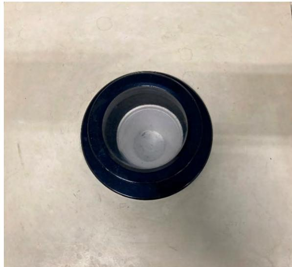
**Abb. 101:** Vakuumpumpstand. Blick in die Probenkammer. In den Styroporbecher wird ein Kunststoffbehälter mit dem Hydrophobierungsmittel und den BKS-Prismen gestellt.
