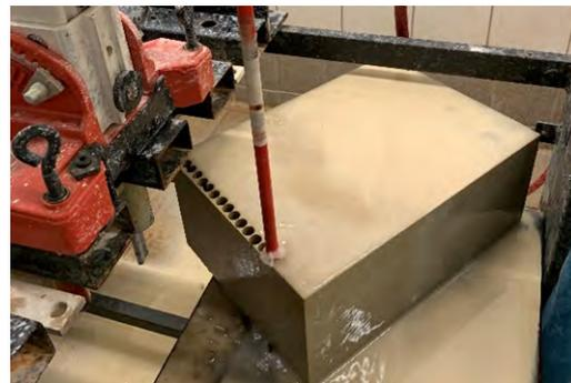
**Abb. 126:** Das Herausbohren der Bohrkern.
