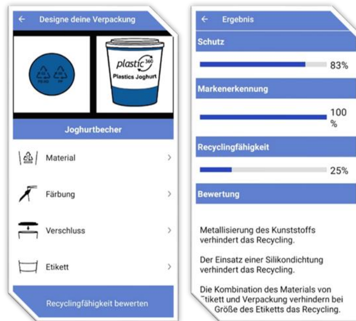
Abbildung 11: Links: Kategorien für das Design des Joghurtbechers. Rechts: Ergebnisauswertung in Prozent mit Ergebnisbeschreibung in Textform für die Recyclingfähigkeit
