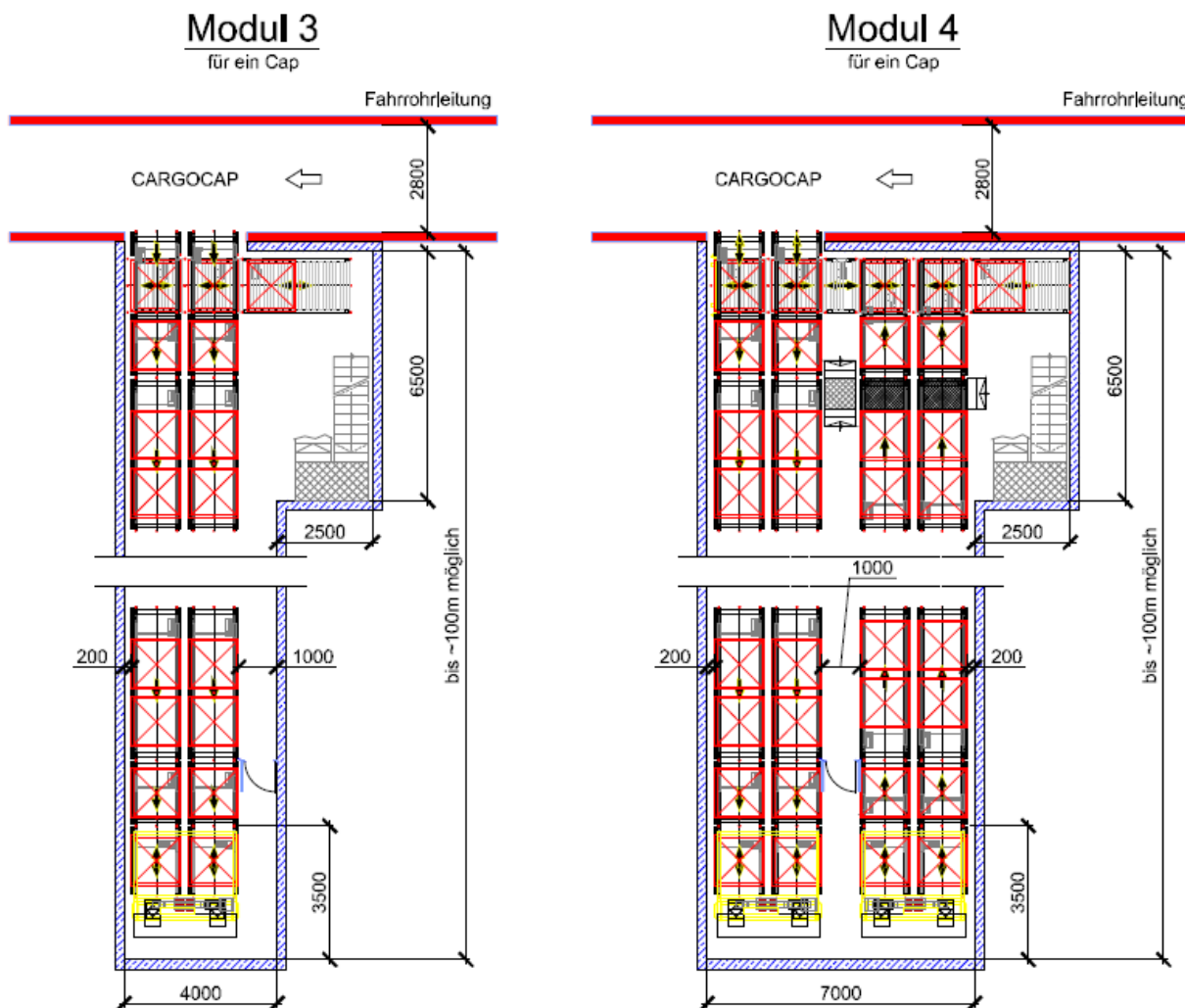
Abbildung 27: Stationsmodule für Sonderfälle (lange Horizontalförderer)
