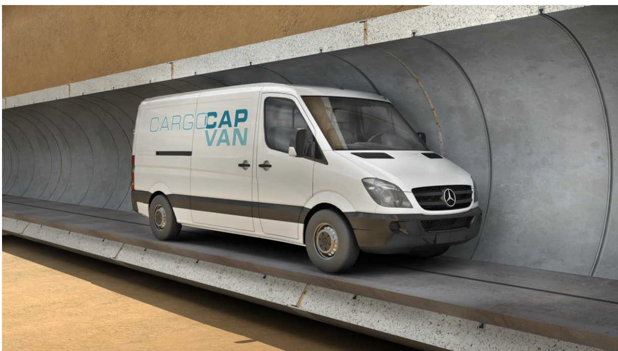
Abbildung 44: Autonom fahrender Transporter in der Fahrrohrleitung DN 3200 [Computergrafik: visaplan GmbH]
