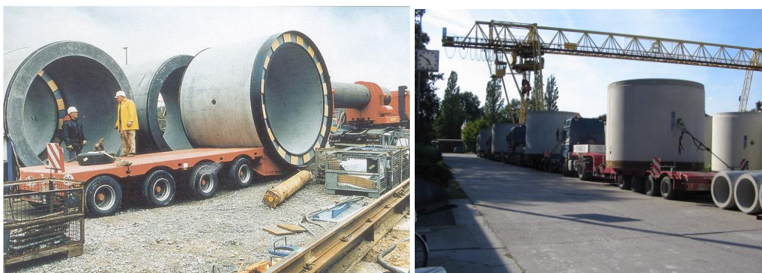
Abbildung 13: Beispielhafter Transport von Stahlbetonrohren DN 3200 mit Tiefladern liegend (links) und stehend (rechts)
