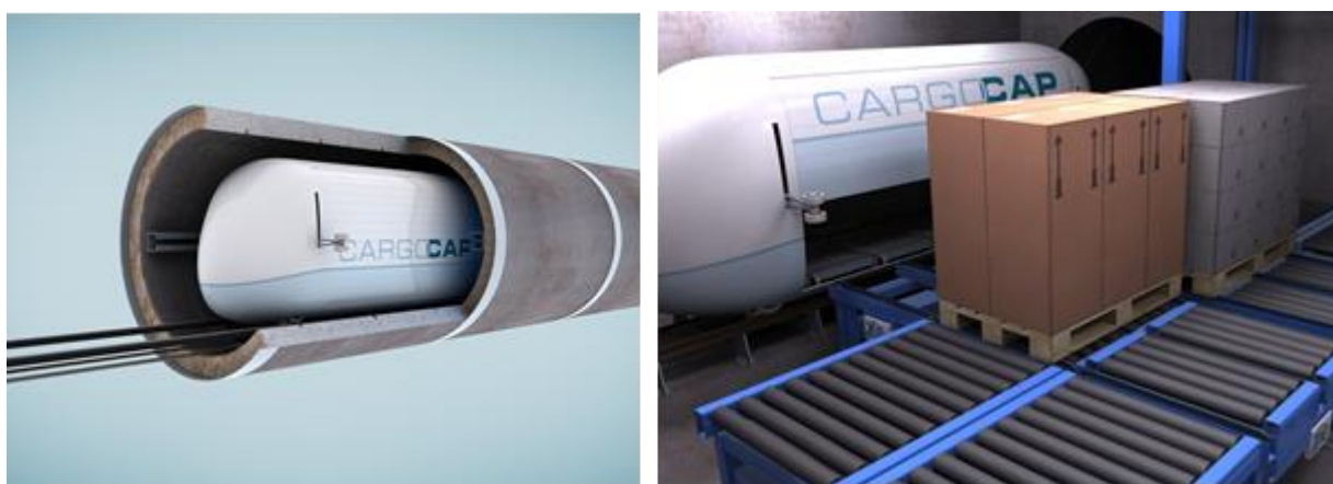
Abbildung 9: Transporteinheit (Cap) im Fahrrohr (links), automatisierte Be- und Entladung eines Caps über konventionelle Rollenbahnen (rechts) [Computergrafik: visaplan GmbH]
