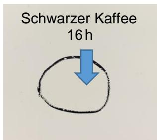
**Abbildung 7:** Beispiel für die chemische Beständigkeit der Beschichtung mit Formulierung 2.
