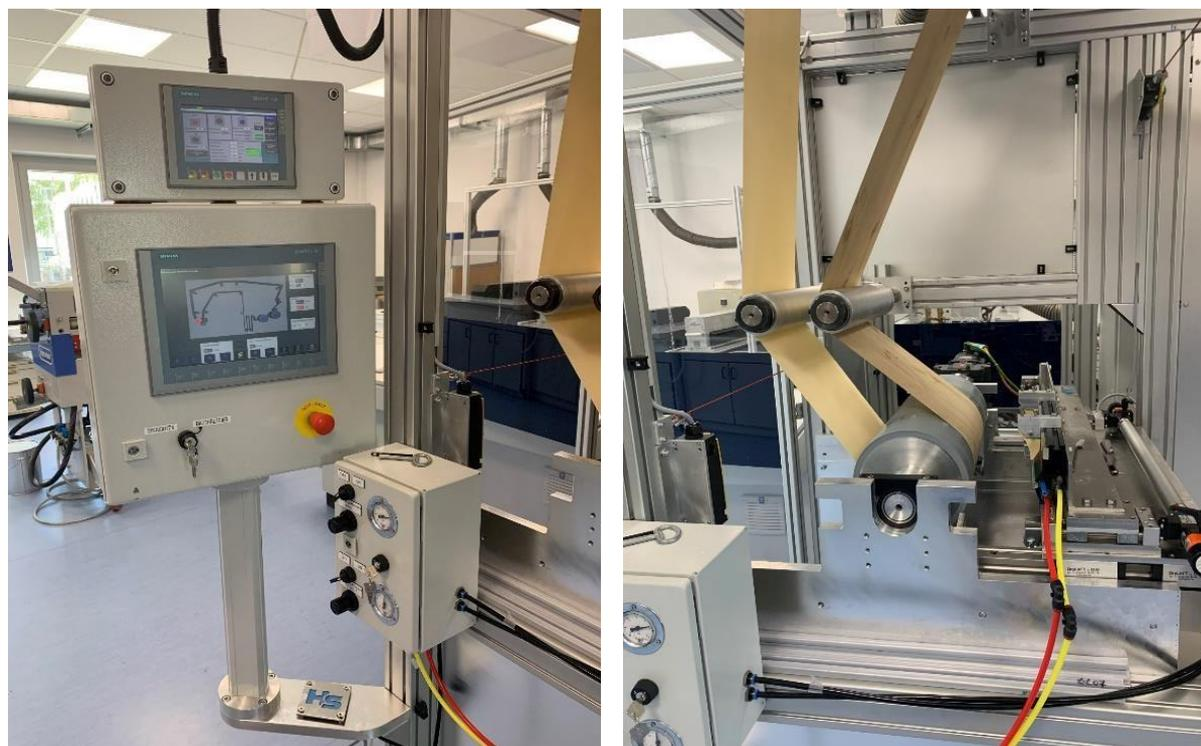
**Abbildung 24:** IOT Pilotanlage Bedienung/Steuerung (links), Gravurrakelsystem (rechts).
