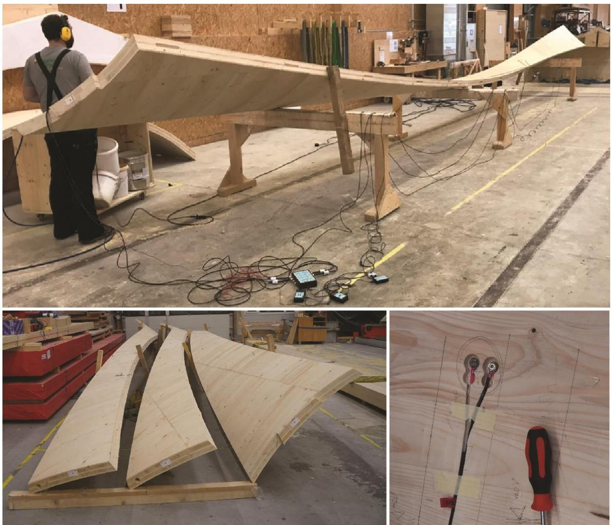
**Abbildung 38.** Installation eines WMC-Überwachungssystems. Sensorprüfung nach der Installation im Werk (oben). Fertige und CNC-detaillierte gekrümmte BSPH-Komponenten (links unten). Detaillierte Darstellung der Sensorelektroden in den BSPH-Komponenten (rechts unten).
