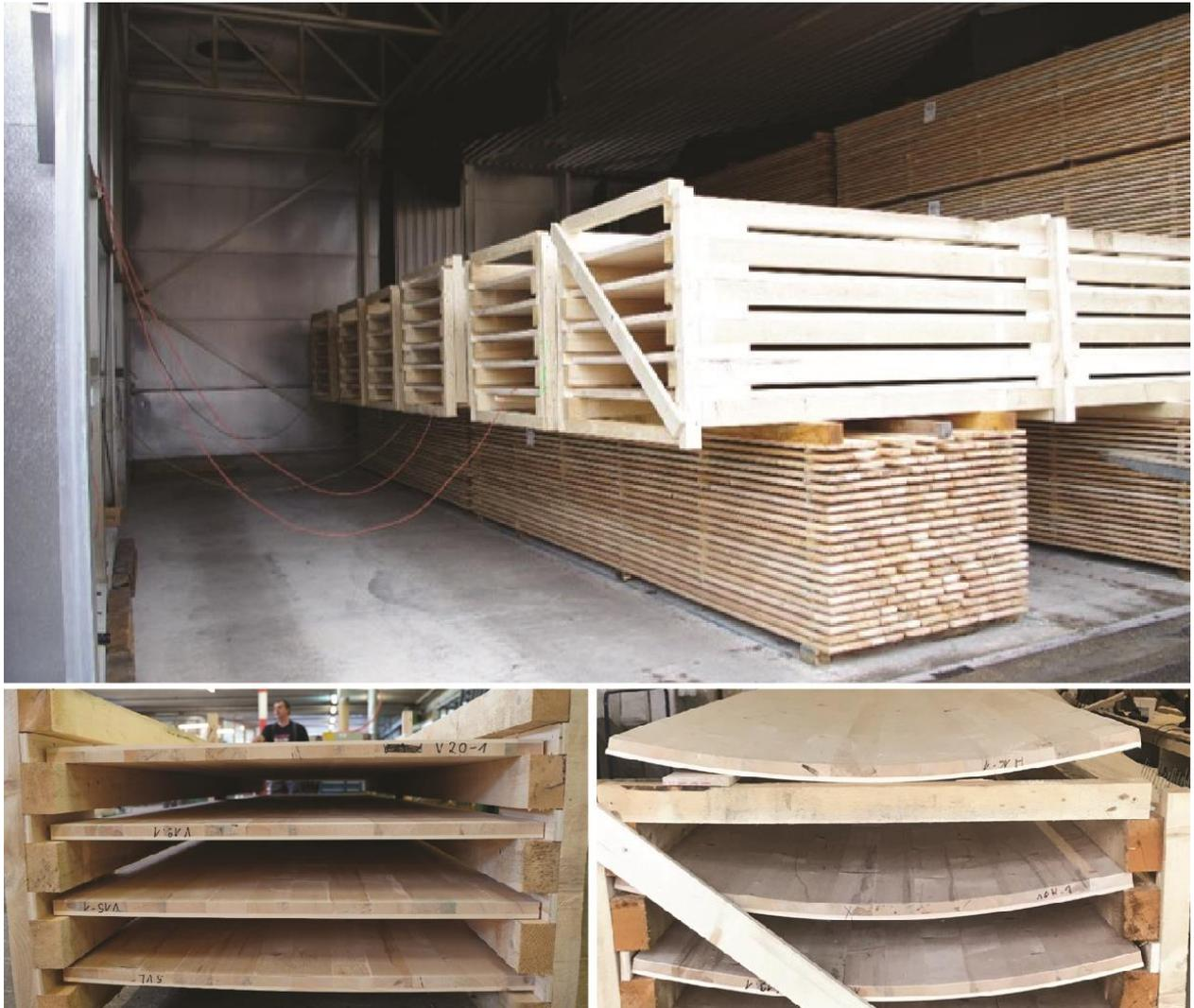
**Abbildung 21. Trockenkammertrocknung der Bilayer aus Fichtenholz. Die Bilayer werden zusammen mit anderen Stapeln und einem Sensor zur Überwachung des WMC (Wood Moisture Content) während der Trocknung in die Trockenkammer geladen (T). Detail der flachen Bilayer mit einem hohen WMC vor dem Trocknen (links) und der gekrümmten Bilayer mit einem niedrigen WMC nach dem Trocknen (rechts).**
