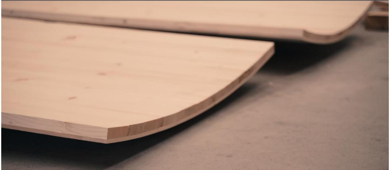
**Abbildung 22.** Selbstgeformte, gekrümmte Bilayer nach dem Trocknen.
