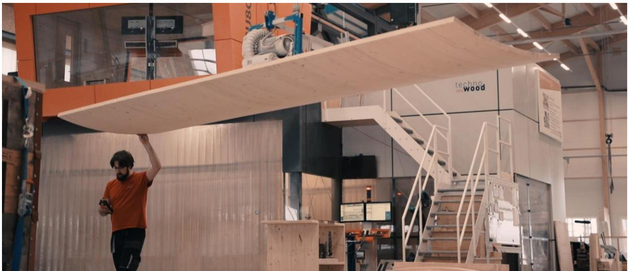
**Abbildung 23.** Weiterverarbeitung der selbstgeformten, gekrümmten Bilayer nach dem Trocknen.
