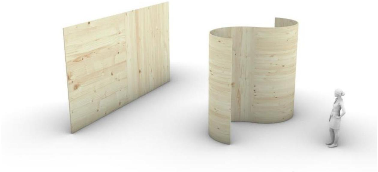
**Abbildung 19. Anwendung des selbstformenden gekrümmten Brettsperrholzes für vertikale Aussteifungs- oder Trennwände in mehrgeschossiger Holzbauweise. (ICD- Universität Stuttgart, Empa).**
