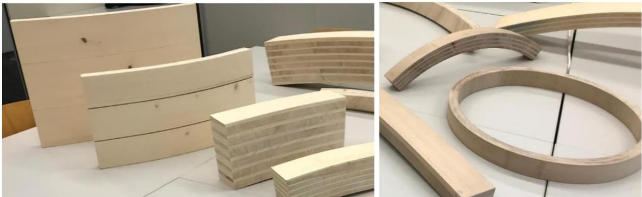
**Abbildung 6. Probekörper aus hygroskopisch selbstgeformtem Brettsperrholz im Rahmen des KTI-Projekts "Intelligente, innovative Herstellung von gekrümmten Holzbauteilen für die Architektur mit komplexer Geometrie" (ICD- Universität Stuttgart, Empa)**
