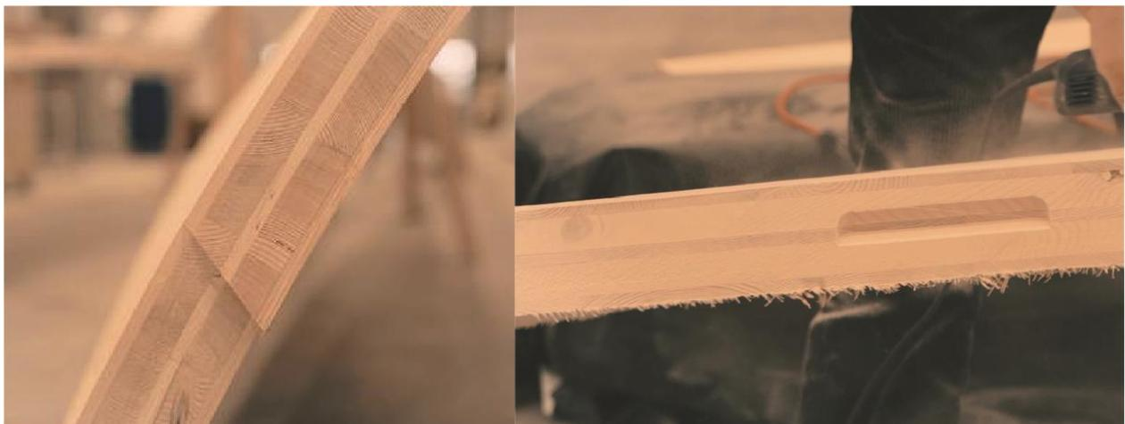
**Abbildung 24.** Querschnitte des fertiggestellten, selbstgeformten gekrümmten Brettsperrholzes. Querschnitt (links). Längsschnitt (rechts) zeigt den 10-30-10-30-10 Schichtaufbau.
