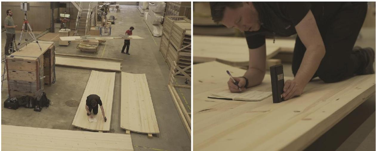
**Abbildung 36. Messung von Krümmung und des WMC in den Bilayern. 3D-Laserabtastung zur Überprüfung der Konsistenz der Krümmung in den größeren Platten (links). Manuelle Messung des endgültigen WMC-Werts pro Platte (rechts).**
