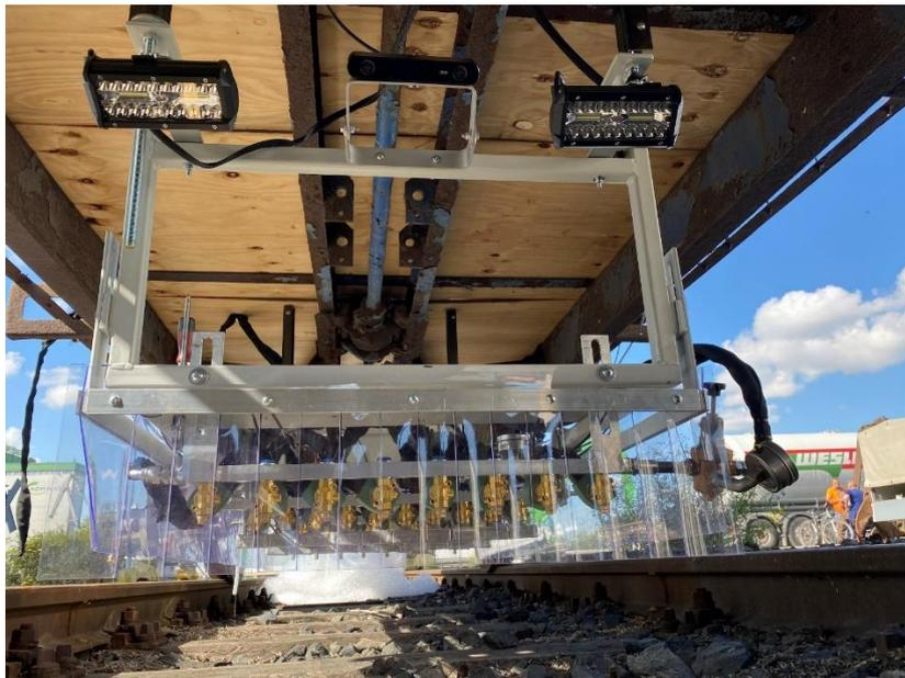
Abbildung 14: Ausbringeinheit für die Versuche auf dem Gleis im Hafen Braunschweig
