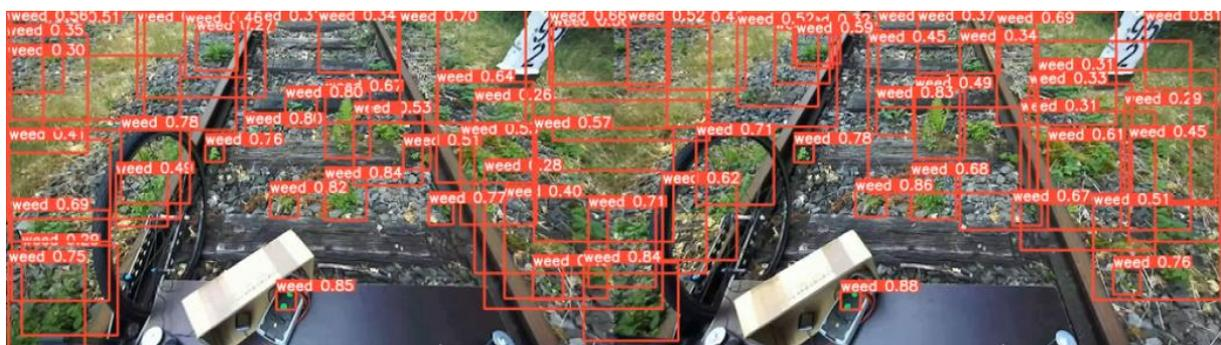
Abbildung 9: Beispielbild der Stereokamera auf einem verkrauteten Gleisabschnitt mit Bestimmtheitsmaß für die Detektion einzelner Pflanzen.
