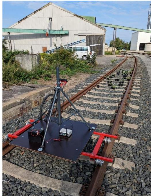
Abbildung 8: Testkamera zur Positions- und Winkelbestimmung, sowie zur Erstellung von Anlerndaten
