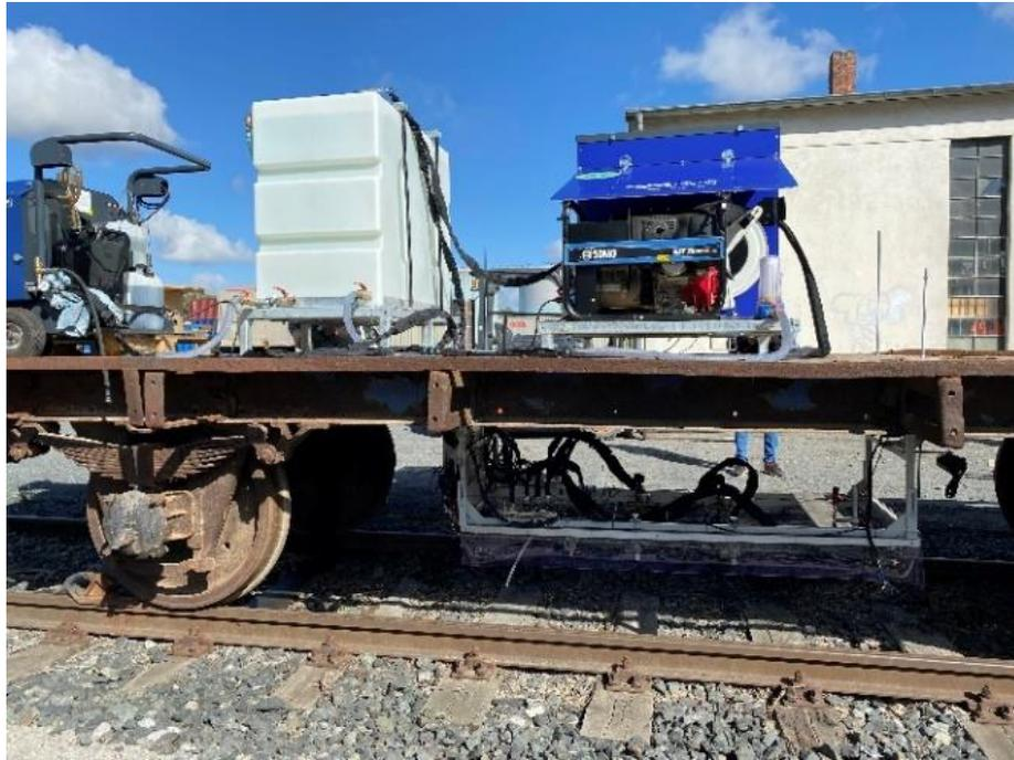
Abbildung 16: Heißwassergerät im Einsatz auf dem Versuchsgleis im Hafen Braunschweig
