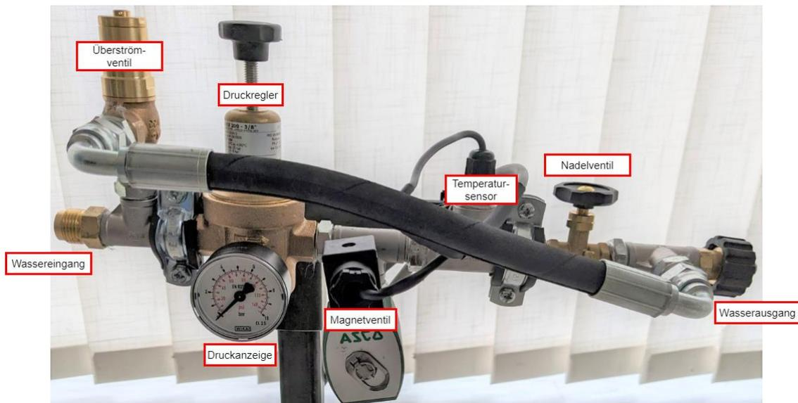
Abbildung 12: Apparatur zum Test von Düsen und Ventilen
