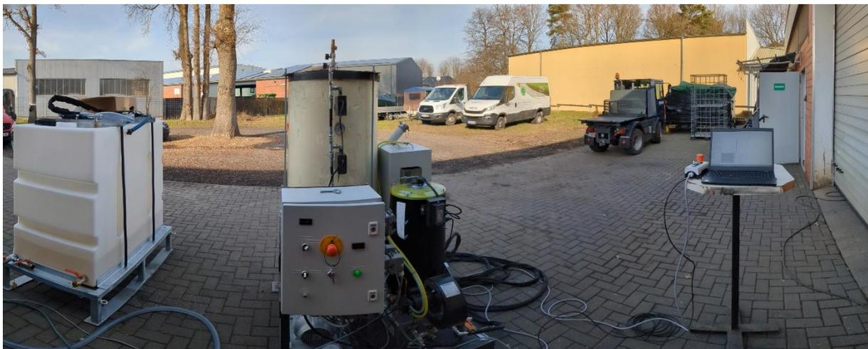
Abbildung 10: Test des linearen Ausbringsystems mit Brenner und isoliertem Kessel
