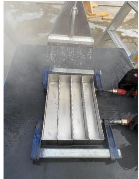
Abbildung 1: Aufbau zur Messung der Quer- und Längsverteilung der Wassermengen für unterschiedliche Düsen- und Lanzentypen
