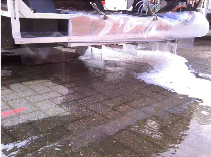
Abbildung 13: Ausbringeinheit mit vier Düsenreihen und Windschürzen (Heißluft + Heißwasser + Heißschaum)
