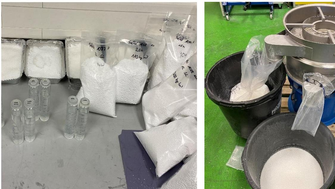
Abbildung 3-5: Links: Laborversuche verschiedener Polymerzusammensetzungen im Ausgangszustand des Polymer-Granulats und nach der CO<sub>2</sub>-Extraktion. Rechts: Vibrationssiebmaschine mit verschiedenen Siebschnitten zur Klassierung der Korngrößen des Polymer-Granulats.
