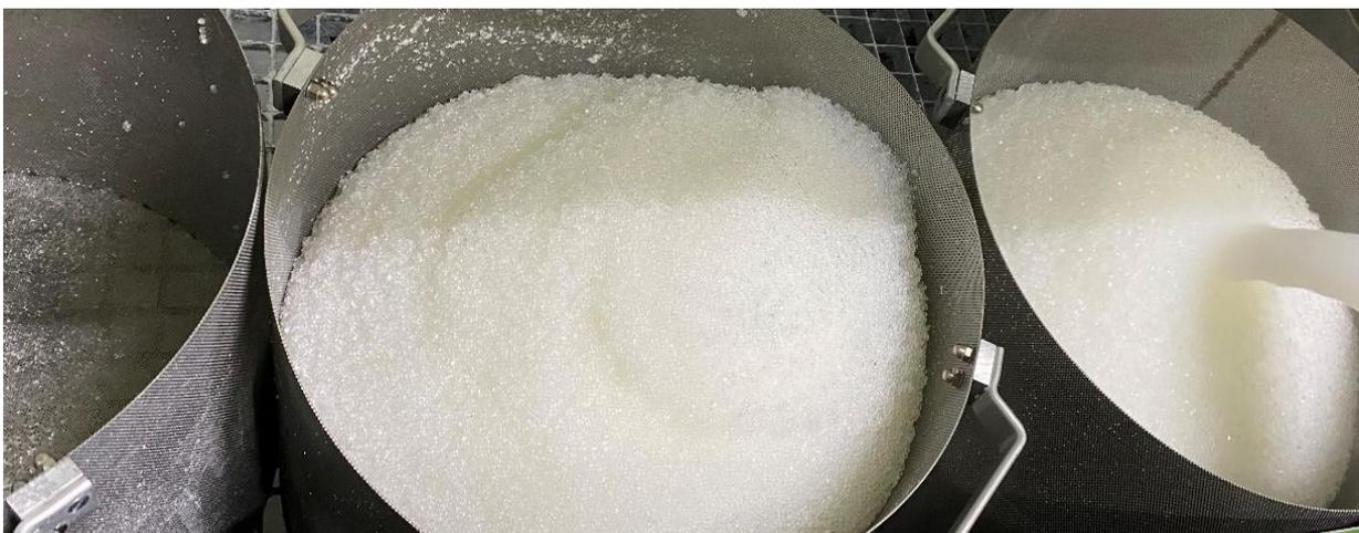
Abbildung 3-3: Fest-Flüssigtrennung der fertigen Reaktion durch Siebkörbe auf einer flüssigkeitsdichten Abtropfwanne. Die Trennung findet unter einem begehbaren Abzug und über Nacht durch gravimetrische Trennung statt.
