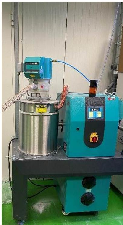
Abbildung 3-4: Wirbelschichttrockner für die Chargentrocknung von Polymer-Granulat oder Schäumen. Der fahrbare Granulattrockner besteht aus einem Trockenlufterzeuger und einem hochwertigen Trocknungsbehälter. Durch den Venturi-Effekt wird das Granulat mittels Vakuumförderung in definierten Zyklen neu angesaugt und zusammen mit der Trockenluft im Kreis gefördert und umgeschichtet.
