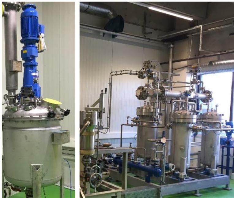
Abbildung 3-2: Links: Polymerisationsreaktor im SUMTEQ-internen Technikum im Betrieb. Mittels Suspensionspolymerisation wird das flüssige Monomer in Polymer-Granulat überführt. Rechts: CO<sub>2</sub>-Hochdruckextraktion. Mittels überkritischem CO<sub>2</sub> werden dort eingelegte Polymer-Granulatpartikel unter Hochdruck volumenaktiviert.
