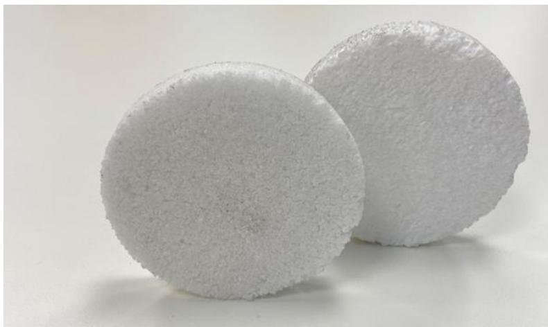
Abbildung 3-10: Selbst hergestellte Versuchsplatten aus Sumfoam-Flakes und -Pulver.
