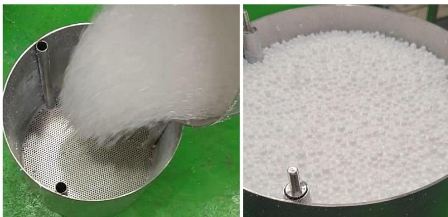
Abbildung 3-6: Links: Polymer-Granulat während der Befüllung in den Schäumkorb. Rechts: Mittels überkritischem CO<sub>2</sub> wurden Polymer-Granulatpartikel unter Hochdruck volumenaktiviert, diese nehmen danach nahezu das gesamte Füllvolumen der Schäummetage ein.
