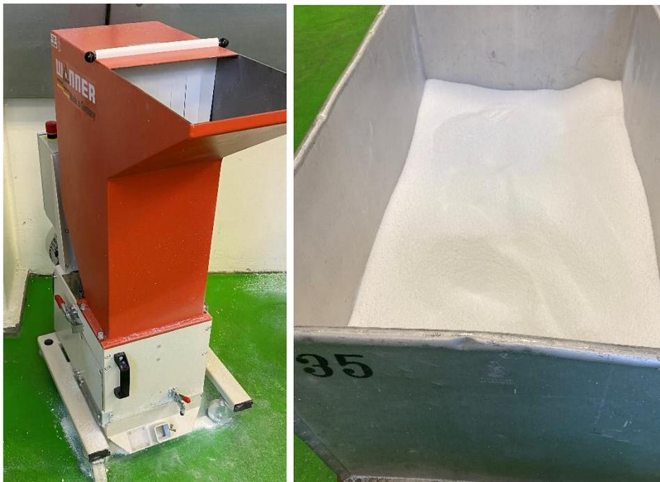
Abbildung 3-8: Links: Geöffnete Schneidmühle für die Vermahlung des Sumfoam-Schaumgranulats in kleine Flakes. Durch Vermahlung in niedrigen Temperaturbereichen, kann die Beschädigung der Nanostruktur vermieden werden. Rechts: Sumfoam in Form von vermahlenden Flakes zur Lagerung und Trocknung an der Atmosphäre.
