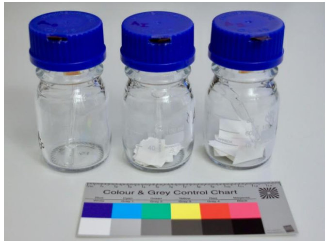
Abb.34: Testaufbau für den Quervergleich klassischer Oddy-Test mit eOddy.
