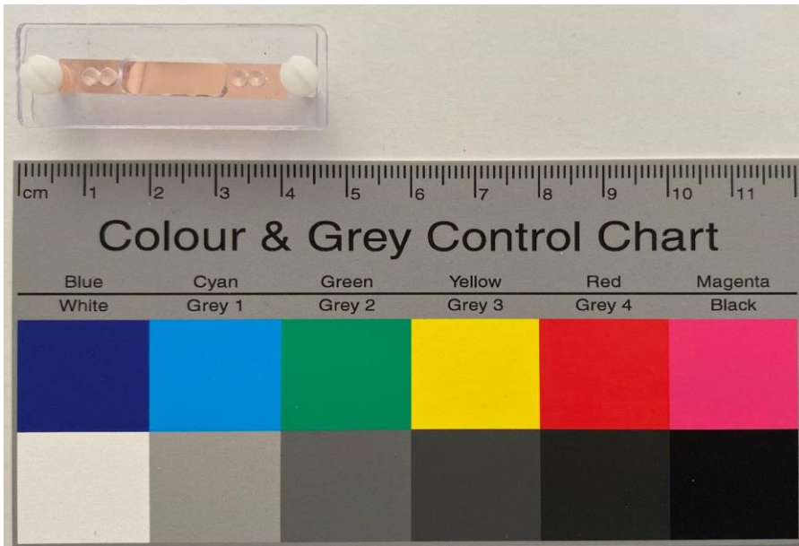
Abb.45: Sensorelement der 3. Generation bestehend aus einer Kupferschicht unter 500 nm Dicke. Aufgrund der mechanischen Empfindlichkeit sind diese Sensorelemente in einer Fassung aus Acrylglas (PMMA) gefasst.
