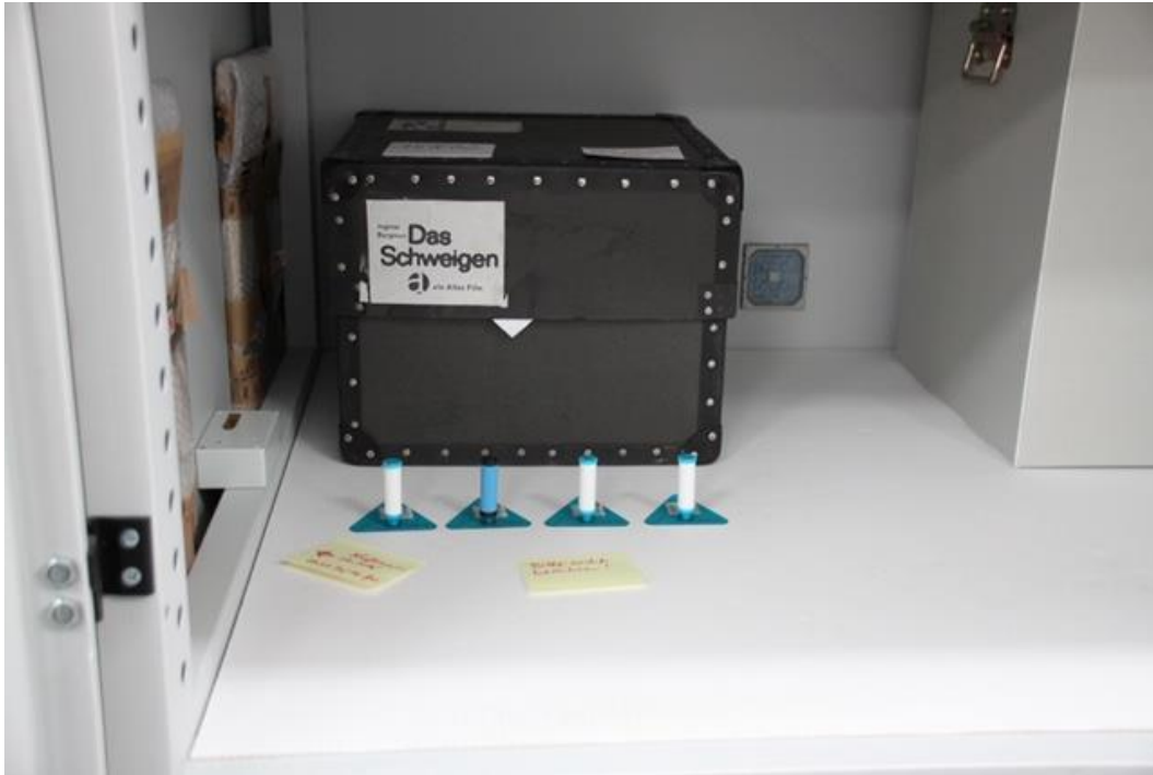
Abb.42: Positionierung des Demonstrators und der Passivsammler im Depotschrank © VG Bild-Kunst, Bonn 2020.
