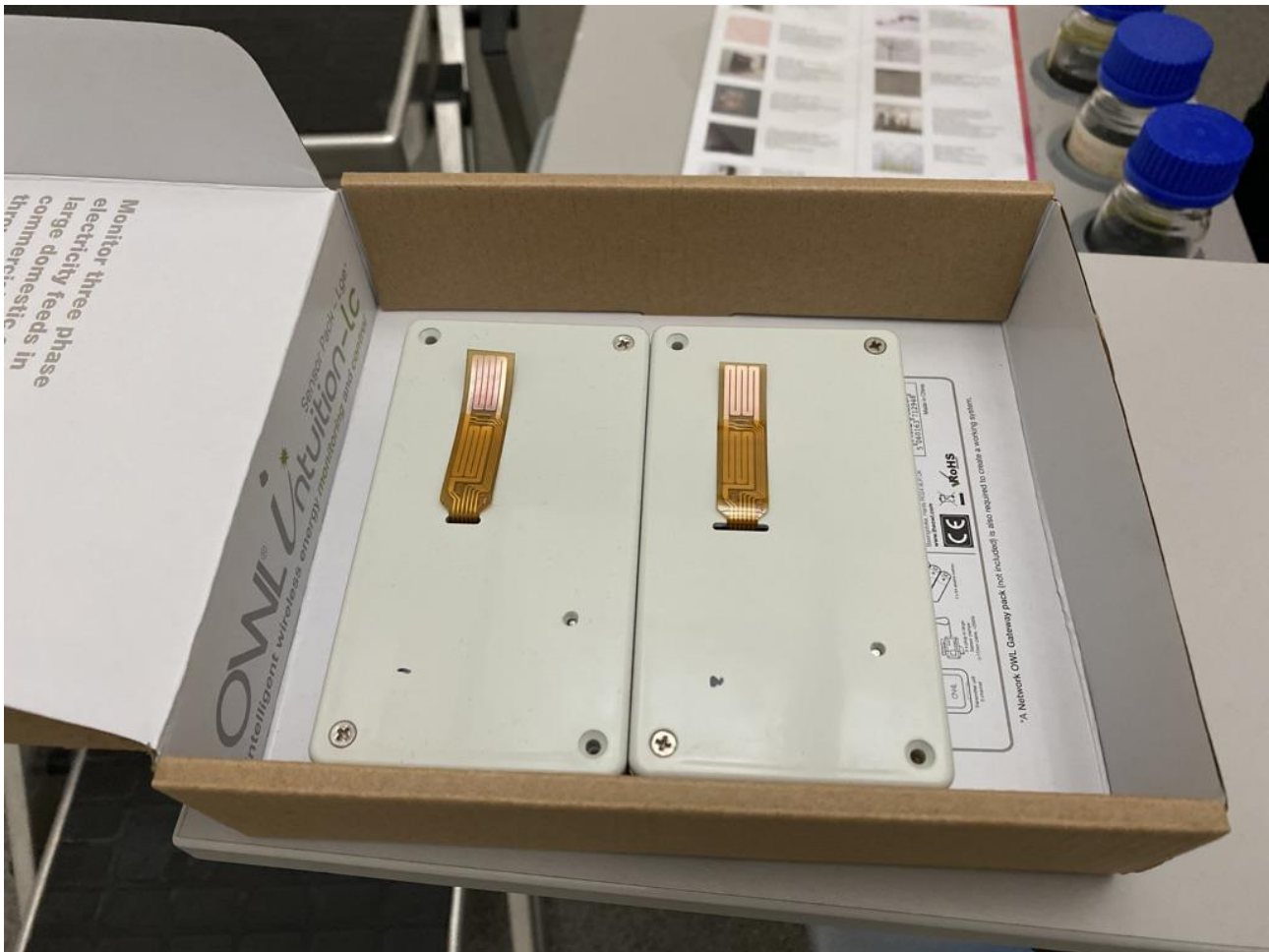
Abb.39: iAir Datenlogger mit Kupfer Foliensensor der 2. Generation.
