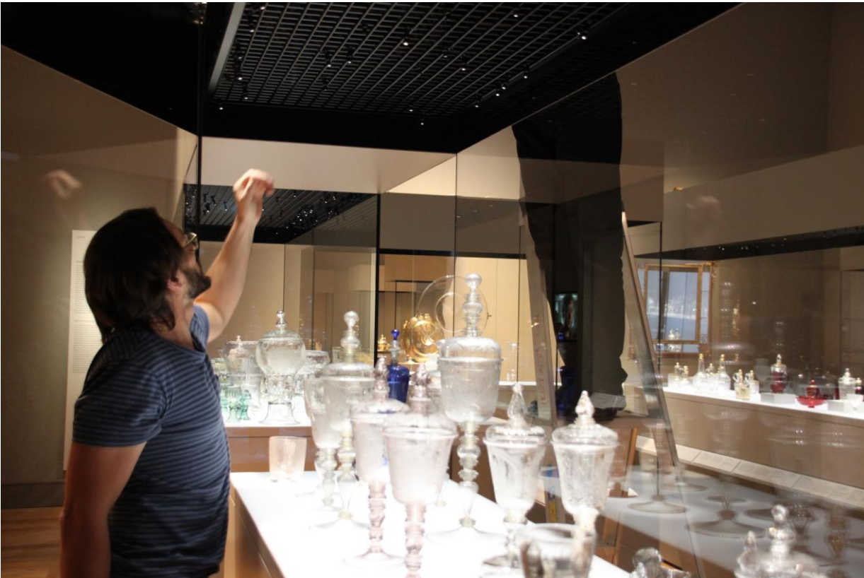
Abb.8: In der Decke der Testvitrine ist die LED-Beleuchtung verbaut. Hier ist auch das Test-Sensorarray montiert und mit Strom versorgt.
