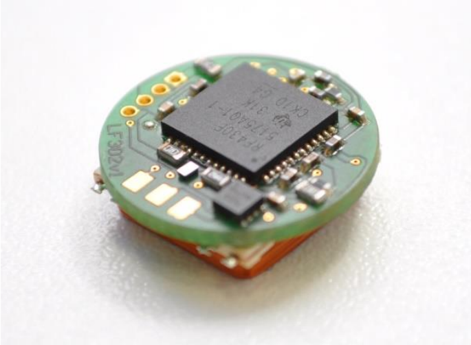
Abb.20: Passives NFC-ISFET-Modul (Near Field Communication). Das Modul wird von außen vor dem Auslesen des Sensors mit Energie versorgt. Anschließend wird der Sensor ausgelesen und die Daten per Funk übertragen.
