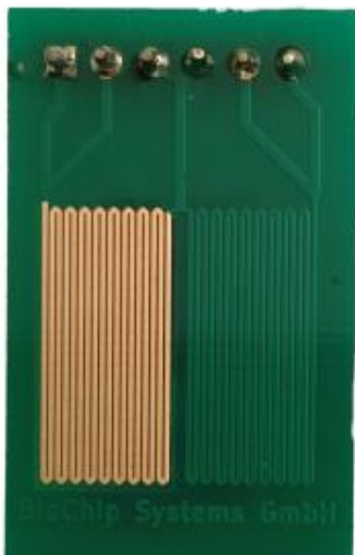
Abb.30: Korrosionssensor Generation 1 mit Kupferstruktur
