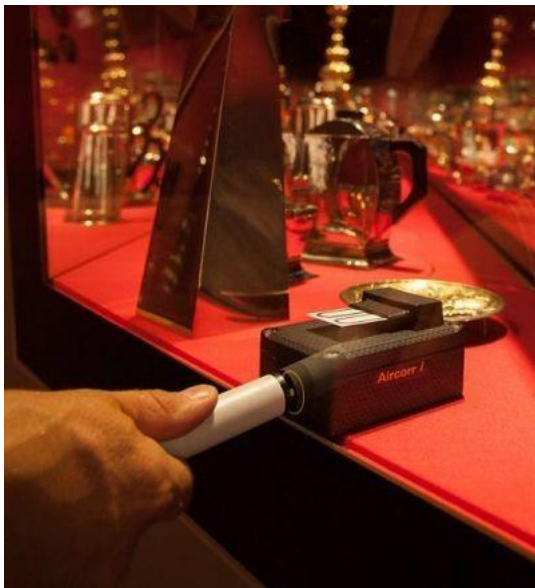
Abb.3: Auslesen eines AirCorr I Sensor mittels Data-Pencil in einer Museumsvitrine (Quelle: www.institut-corrosion.fr/wp-content/uploads/2018/03/AirCorr-brochure-v2016.pdf )
