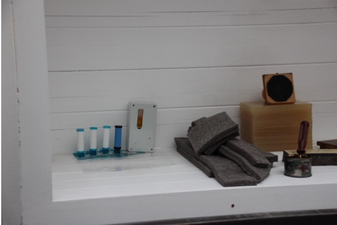
Abb.41: Positionierung des Demonstrators und der Passivsampler in der Modellvitrine (J. Beuys) © VG Bild-Kunst, Bonn 2020.
