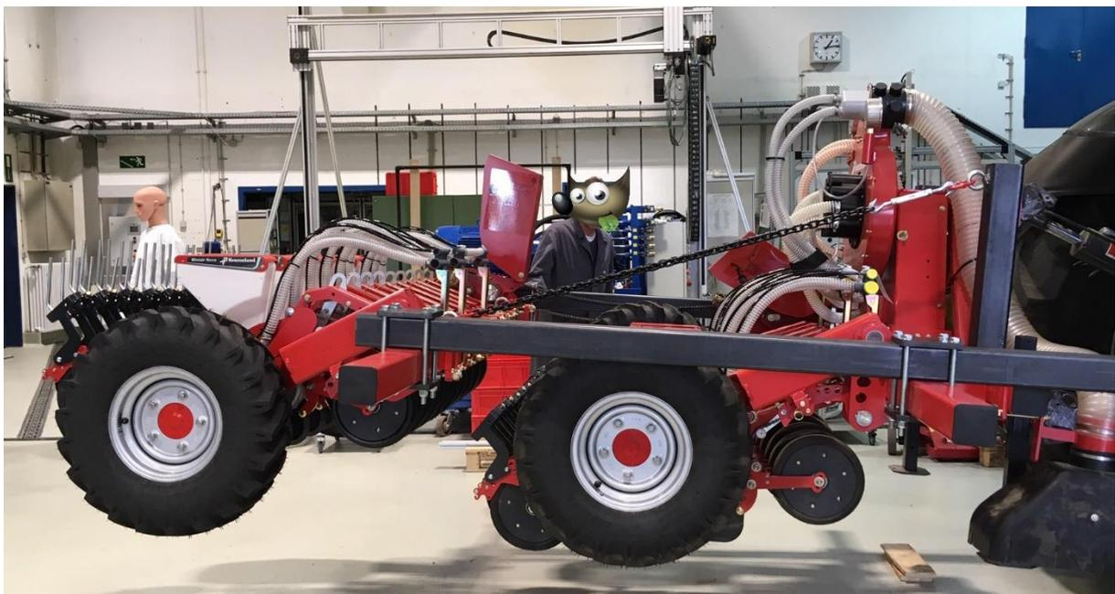
Abbildung 3: Gleichstandsaat-Sämaschine mit zweibalkigem Aufbau.
