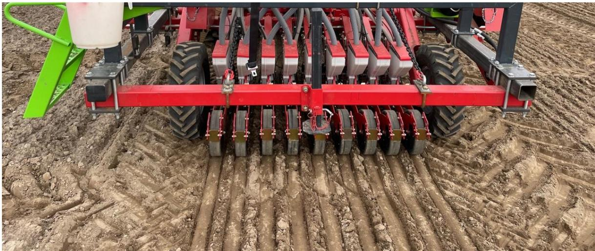
Abbildung 5: Gleichstandsmaat-Sämaschine mit einbalkigem Aufbau.
