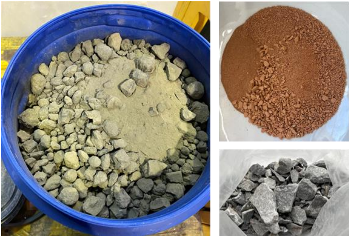
Bild 2 Die Materialien Klinker (l.), Ziegelschleifstaub (o. r.) und Kalkstein vor der mechanischen Zerkleinerung in der Kugelmühle
