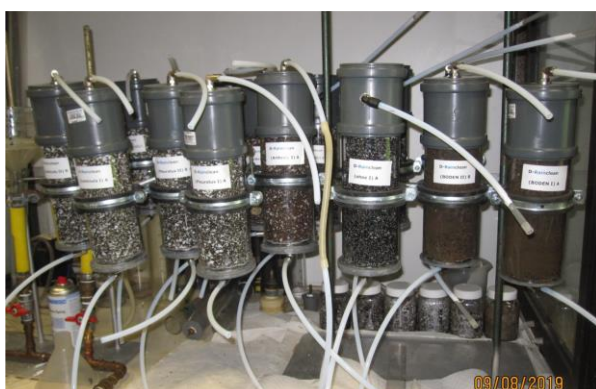
Abbildung 11: Aufbau Säulentest (links) und Rückhalt für verschiedene Testsubstrate (rechts).
