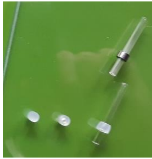
Abb. 3: oben: Liner mit Grafitdichtung, unten: PDMS-Septum, ausgestanztes Septum, Liner mit PDMS-Dichtung
