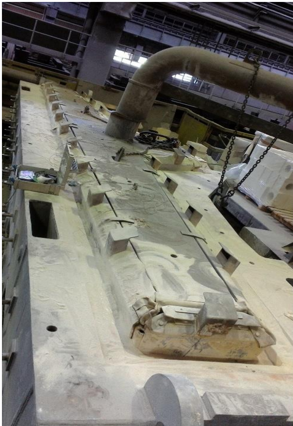
Bild 4 - Verteiler mit Schablone im Heizstand
