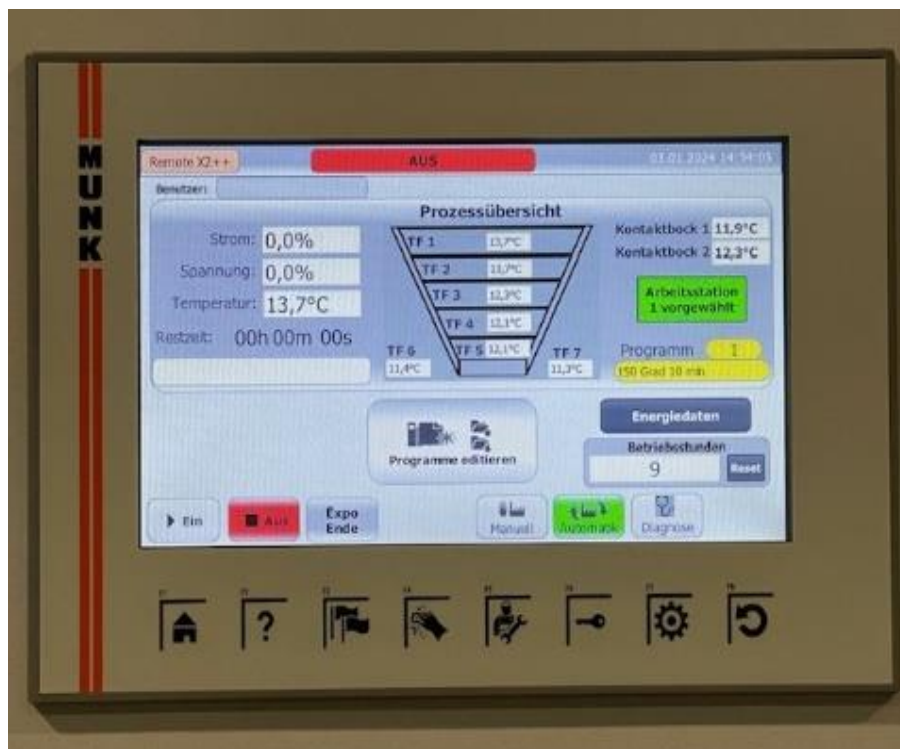
Bild 17 – Übersichtsseite der Steuerung
