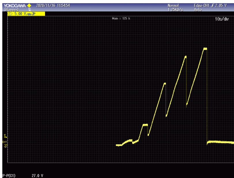
Abbildung 12: Verlauf der Kondensatorspannung bei einer Magnetisierung mit verkürzten Pulsen
