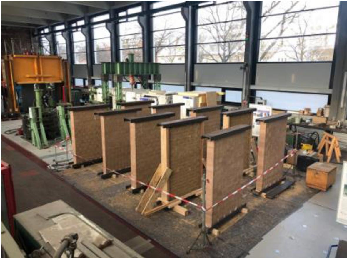
**Abbildung 6:** Geschosshohe Wandprüfkörper während der Lagerung in der Prüfhalle inklusive seitlicher Einfassung der Probekörper aus NF-Steinen
