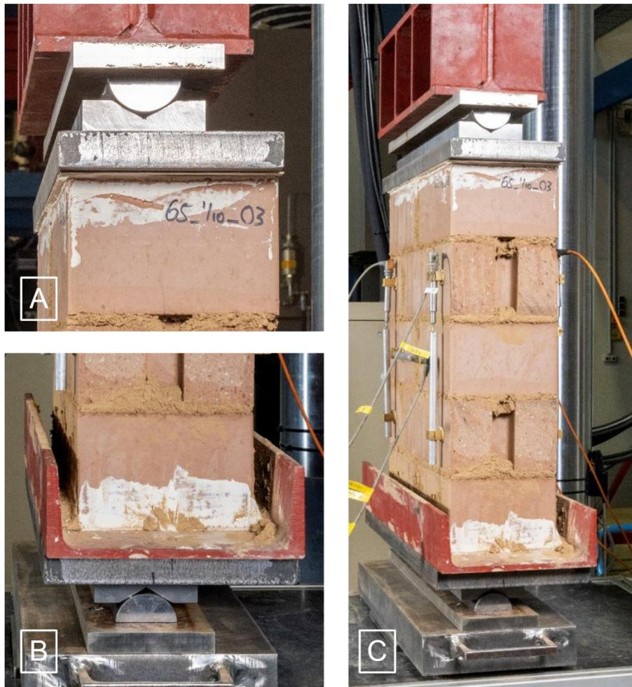
**Abbildung 5:** Obere (A) und untere (B) Lasteinleitung der exzentrischen Mauerwerksdruckversuche sowie Probekörper aus 3DF-Steinen nach Einbau im Versuchsstand (C)
