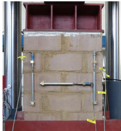
**Abbildung 4:** Prüfkörpergeometrie mit Anordnung der Messstreifen (oben) und Mauerwerksprobekörper nach Einbau in den Versuchsstand (unten) jeweils für NF und 3DF Steinformate
