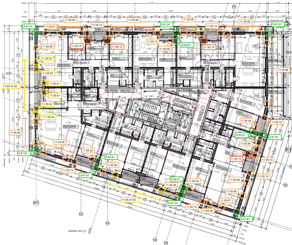
Abb. 24: Übersicht horizontaler Wärmebrücken im Gebäudeteil Turm (KuK)
