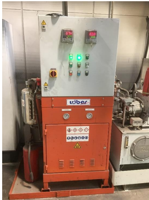
Konventionelles Begasungsgerät, Bild 19
