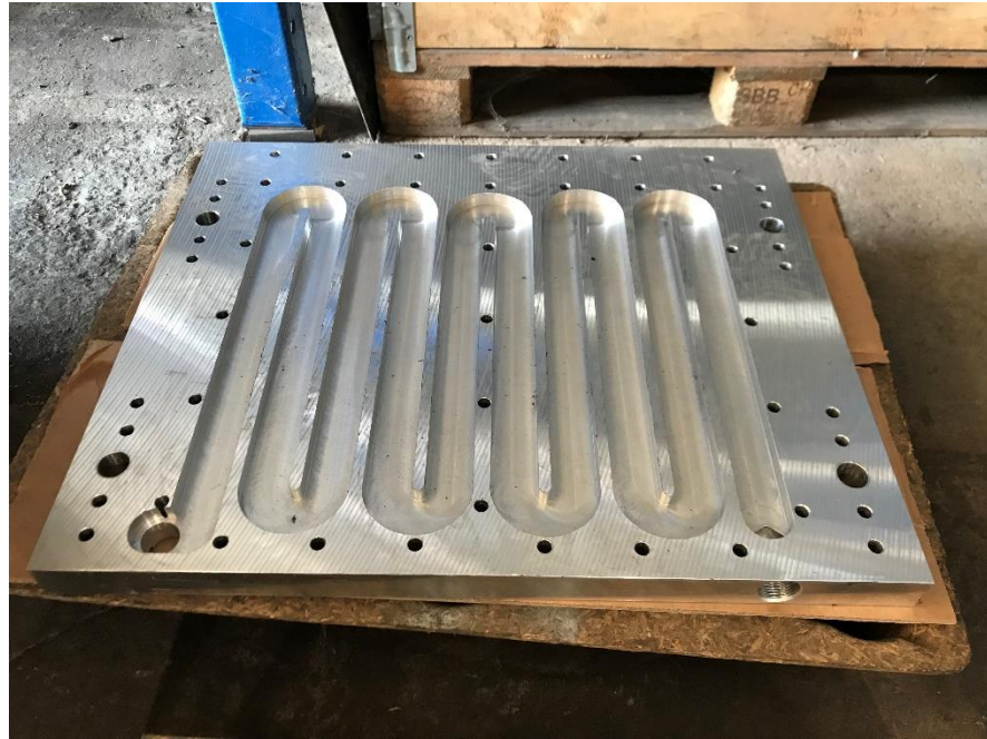
Modul der Vorwärmung, Bild 4
