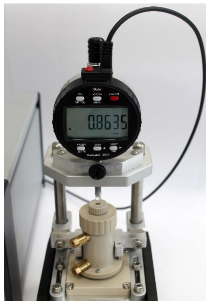
Abbildung 4.2: Detailansicht der Messzelle mit seitlichen Anschlüssen für Messelektrode und Schutzringelektrode. Der Glasstab im Deckel überträgt die Längenausdehnung der Probe auf die Messuhr.
