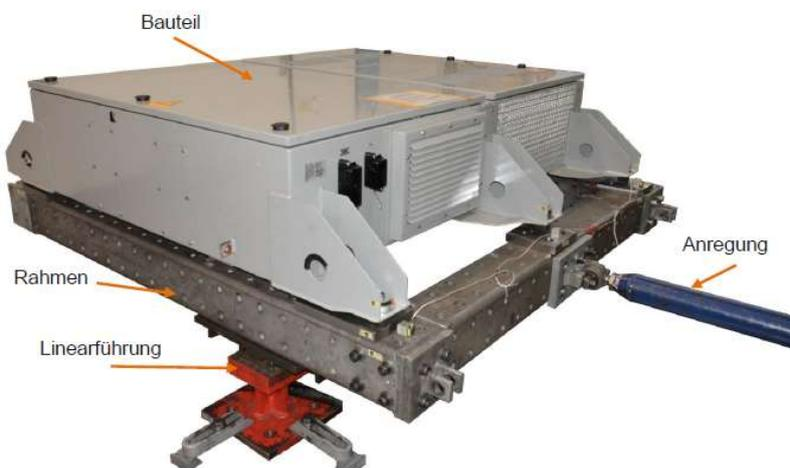
Abbildung 15: Prüfstands Aufbau für die Prüfung in Querrichtung
