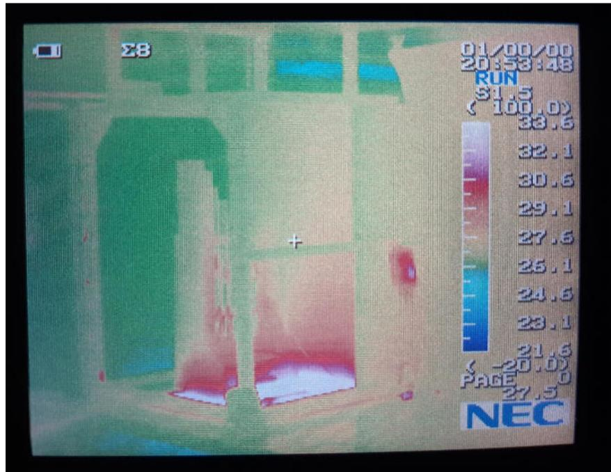
Die Temperaturverteilung nach dem luftfeuchtegeregelten Betrieb (Abb. 15) ist deutlich gleichmäßiger, als nach dem Dauerbetrieb des Heizteppichs (Abb. 14).
