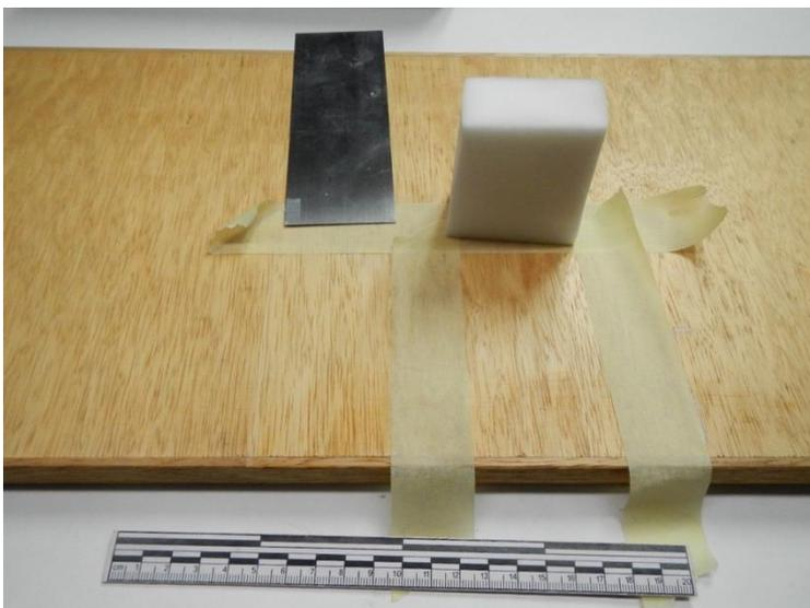
**Abb. 78 links Probefläche 1:** Oberfläche samt Beschichtung mit einer Ziehklinge entfernt, **rechts Probefläche 2:** Oberfläche vom Großteil der anhaftenden Schimmelpilze mit einem Reinigungsschwamm aus Melaminharz gereinigt.
