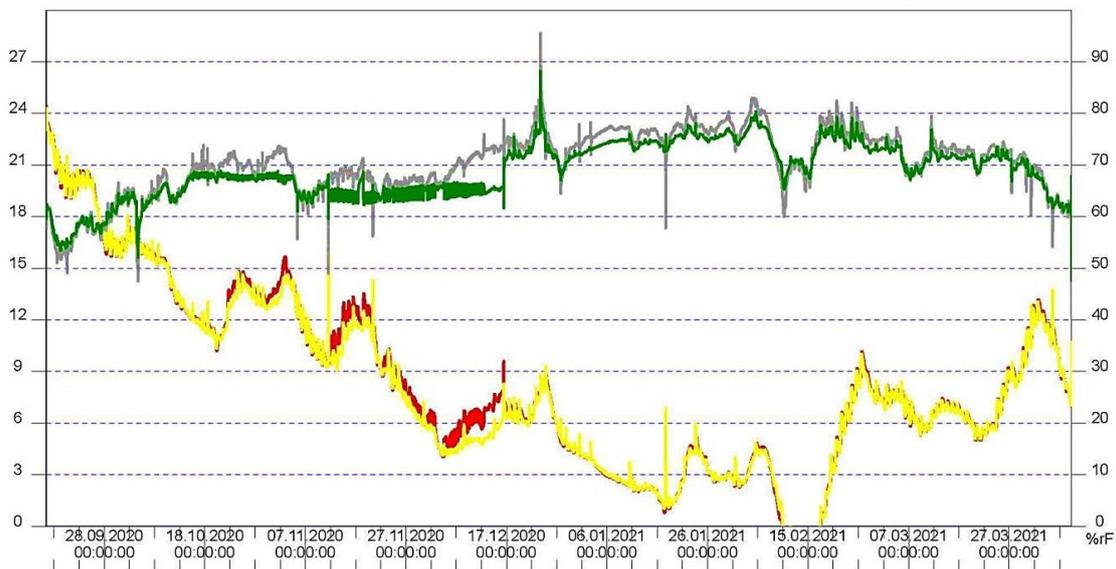
Abb. 65 Klimadiagramm für die Orgel in Wöllnitz für die Zeit während (16.09.2020 – 16.12.2020) und nach dem Trocknungsversuch. Die Betriebsphase und Leistung des Entfeuchters sind an der grünen Kurve sichtbar. Insbesondere zwischen dem 11.11.2020 und dem 16.12.2020, als das Gerät auf einen Zielwert von 65% rel. F. eingestellt war, ist die Reduktion und Stabilisierung der Luftfeuchte erkennbar.
