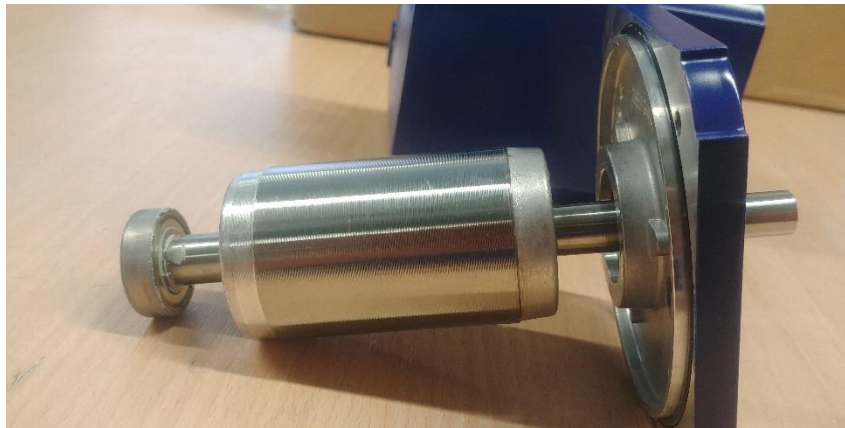
Abbildung 24 Fertiger Rotor des Motors Ia mit festem Lagerschild A-seitig und Kugellager B-seitig. Das Blechpaket zeigt keine fehlerhaften Stellen, an denen die Stege komplett abgedreht wurden.
