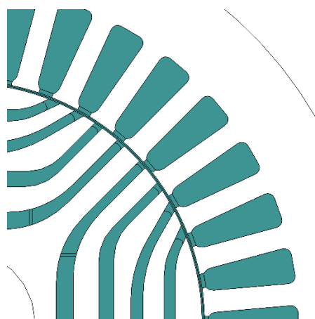
Abbildung 46 Relative Permeabilität des Rechengebiets zur Bestimmung der Induktivitäten mit einer linearen, zweidimensionalen Finite Elemente Analyse am Beispiel von Motor IIb. Die weißen Bereiche zeigen ideal leitfähiges Eisen ( \mu_r \rightarrow \infty ), die gefärbten Bereiche Luft ( \mu_r = \mathbf{1} ). Die Eisenstege wurden durch Luftbereiche ersetzt, um einen magnetischen Kurzschluss im Rotor bei der Berechnung zu vermeiden.
