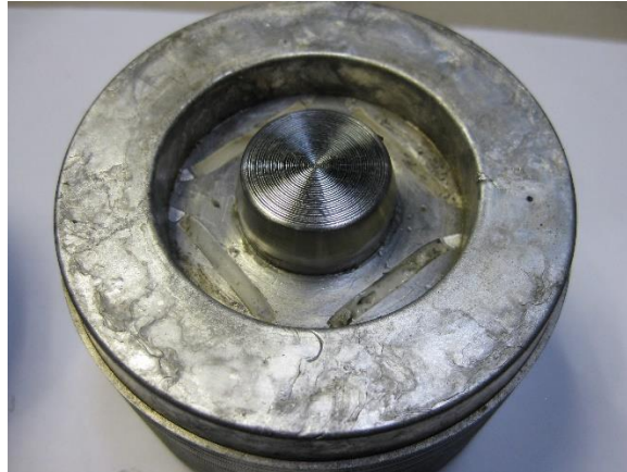
Abbildung 19 Vergossener Rotorkörper von Motor IIb. Der Rotorkörper bleibt durch das eingebrachte Epoxidharz während des Vergießens des Aluminiumkäfts in seiner gewünschten Form.
