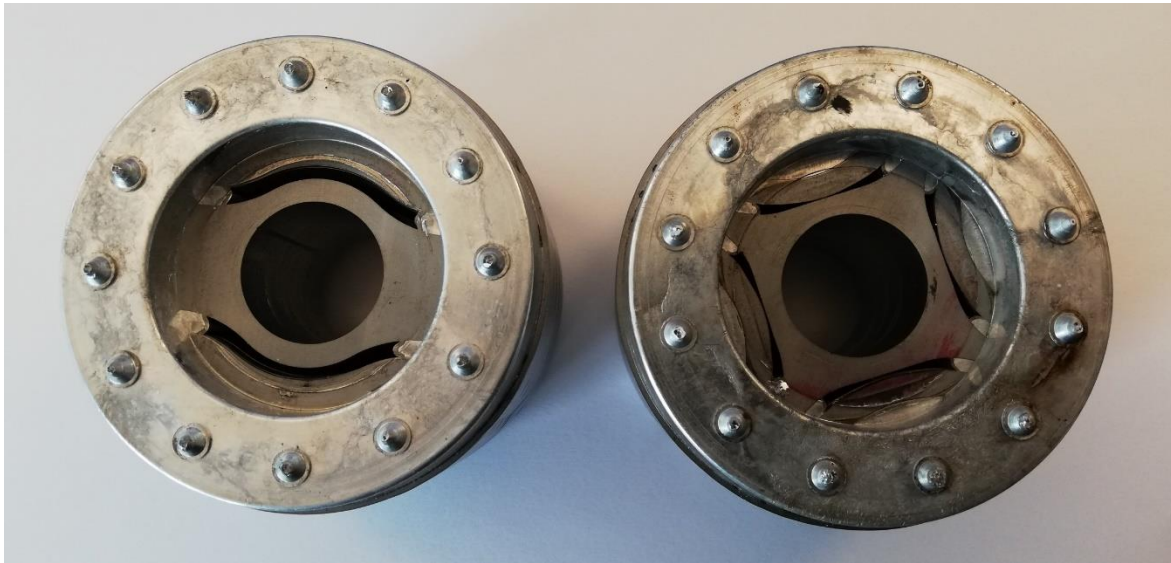
Abbildung 18 Verformung der Rotorblechpakete der Motoren IIa und IIb durch Vergießen der Flusssperrren mit Aluminiumdruckguss. Links: verbogene Stege (Motor II). Rechts: vollständig eingedrückte Bereiche sowie sichtbarer Aluminiumüberschuss in zweiter Flusssperrre (Motor IIb).
