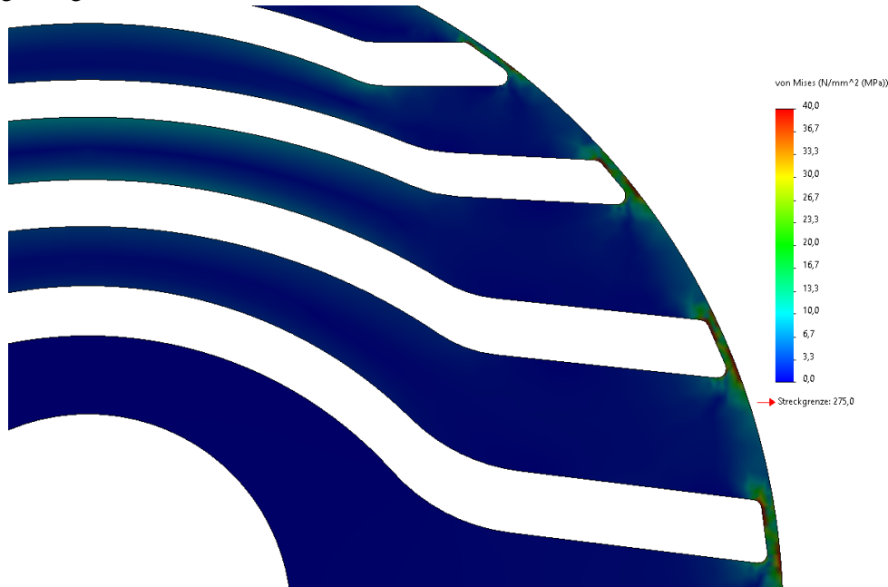
Abbildung 16 Berechnung der mechanischen Festigkeit des 2-poligen Rotors von Motor Ia bei doppelter Nenndrehzahl (6000 1/min). Die Vergleichsspannung liegt im gesamten Blechpaket weit unter der angenommenen Streckgrenze von 275 \text{ N/mm}^2 .
