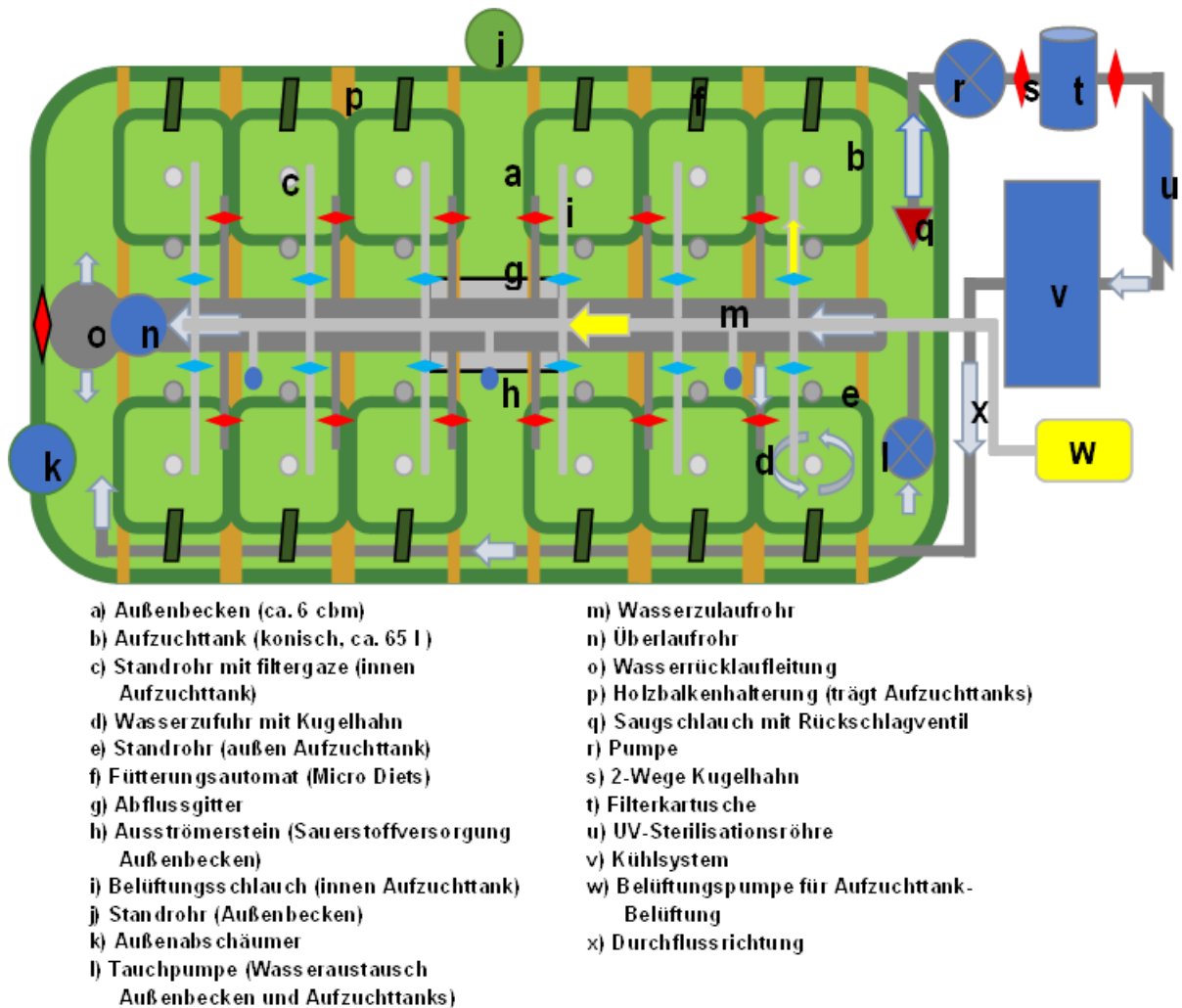
ABB. 10 SCHEMATISCHE DARSTELLUNG EINES DER ZWEI EINHEITEN DES LARVENMODULS
