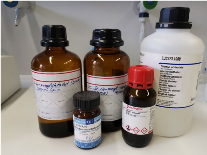
Abbildung 2-7: Beispiele verschiedener Reinsubstanzen, die als Additive in Kunststoffmaterialien zum Einsatz kommen und teilweise schon auf der SIN (substitute it now) gelistet sind. Quelle: A. Fath, Hochschule Furtwangen.
