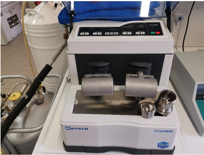
Abbildung 2-5: Cryogenmühle von Retsch mit Mahlbehälter und Schlagkugel. Quelle: A. Fath, Hochschule Furtwangen.
