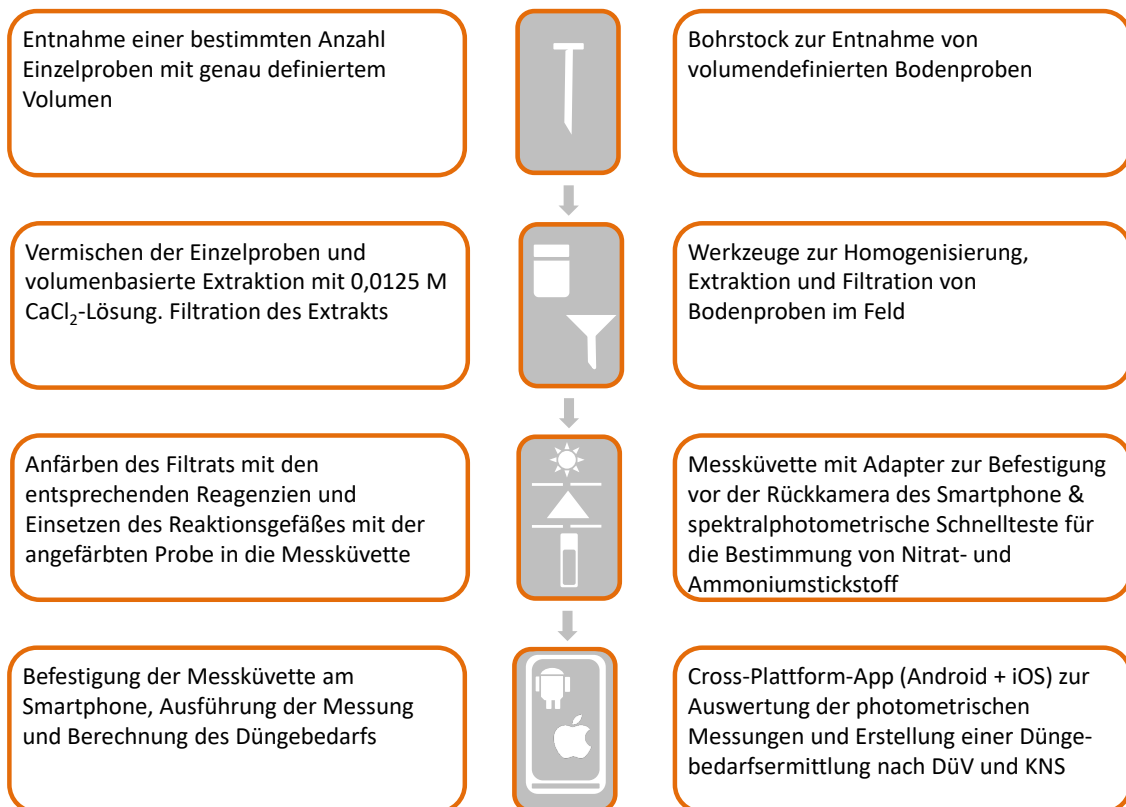
Abb. 1: Ablauf der spektralphotometrischen N_{\min} -Bestimmung (links) sowie die zu entwickelnden Hard- und Softwarekomponenten (rechts)
