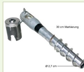
Abb. 1: Bohrstockprototyp mit dem aufsteckbaren Adapterkopf für Schlagschrauber
