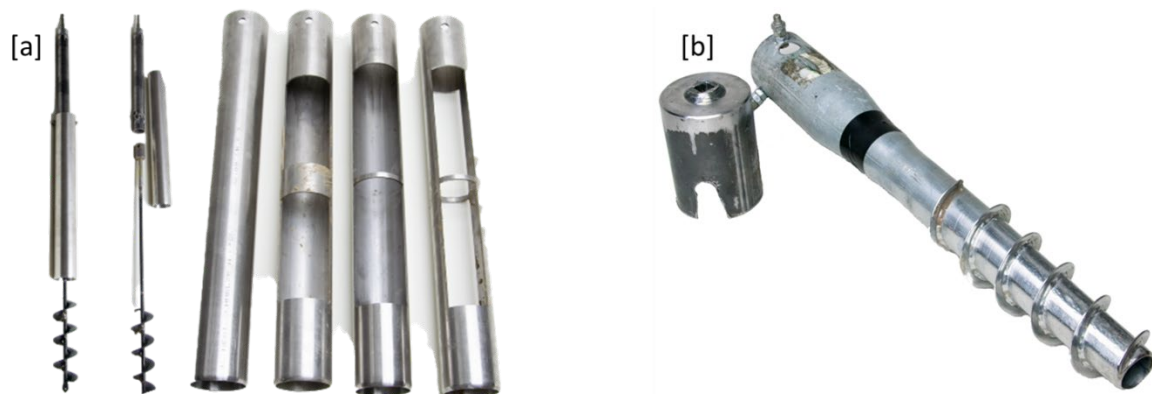
Abb. 4: Drittes und viertes Konzept eines Werkzeuges für die volumenbasierte Probenahme ([a] mittels eines Erdbohrers in den Boden eingezogener Bohrstock und [b] konisches Hohlrohr mit Außengewinde und Adapter zum Anschluss an den Schlagschrauber)
