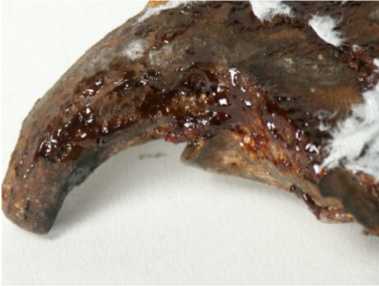
Abb. 3: klebriger Film auf der Oberseite des Schleierbretts aus Ebersdorf (Quelle LfDS)
