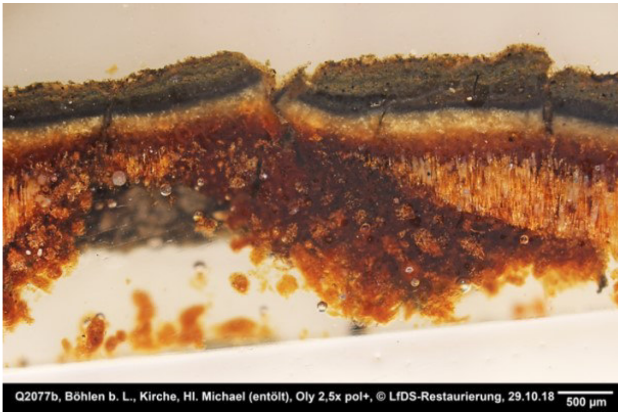
Abb. 30: Querschliff, Holzträger mit veröltter Fassung nach der Entölung, HI. Michael (VIS)
