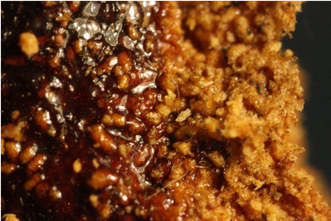
Abb. 11: Makroaufnahme (5fach) offener Holzsubstanz nach der Entölung, HI. Michael, Böhlen
