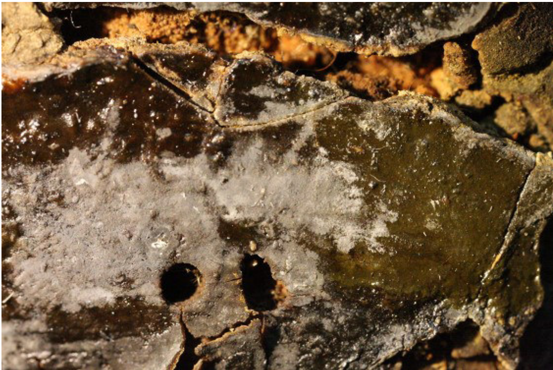
Abb. 14: Makroaufnahme (5fach) Zustand der Fassung nach der Entölung, HI. Michael, Böhlen
