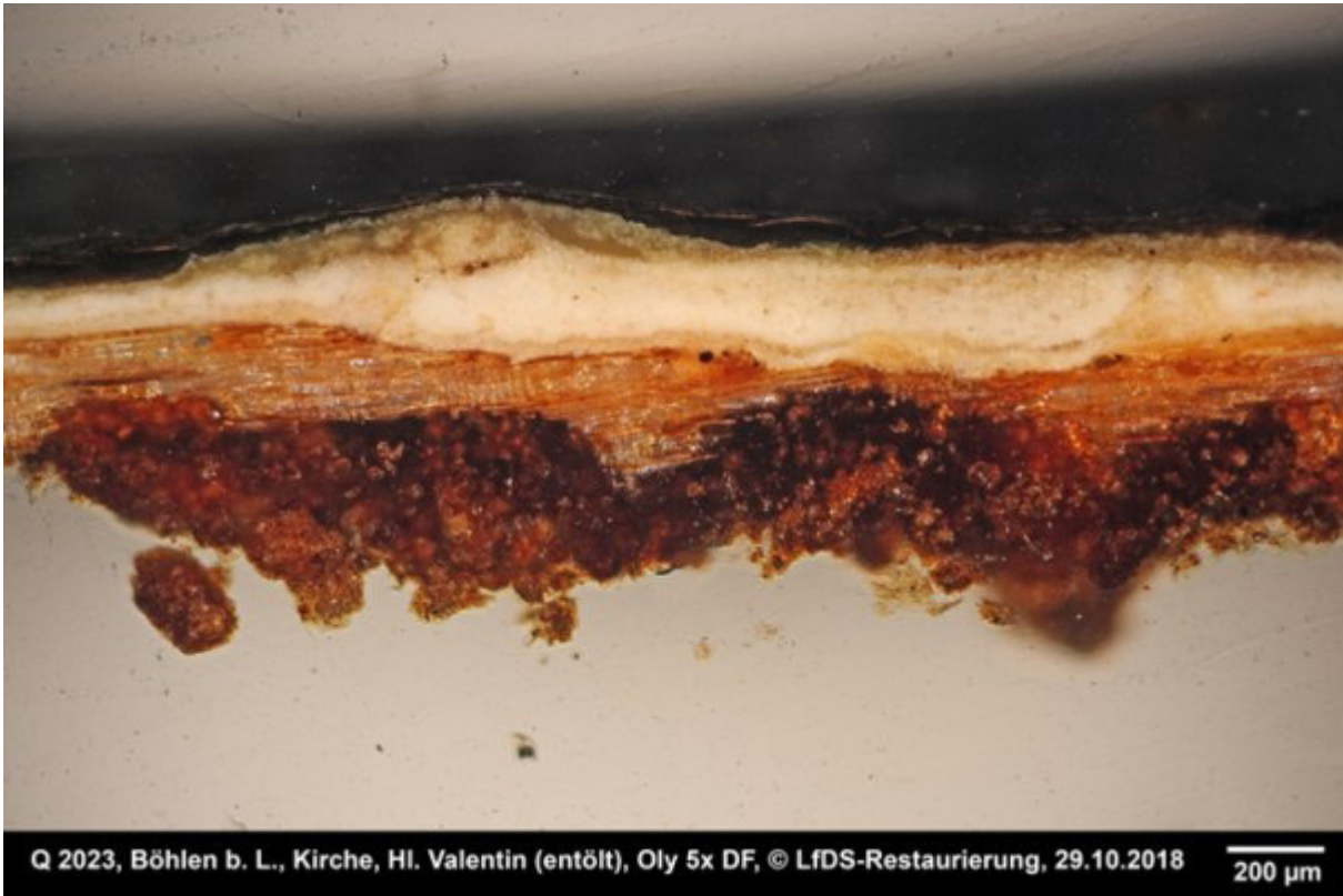
Abb. 28: Querschliff, Holzträger mit verölter Fassung nach der Entölung, HI. Valentin (VIS)
