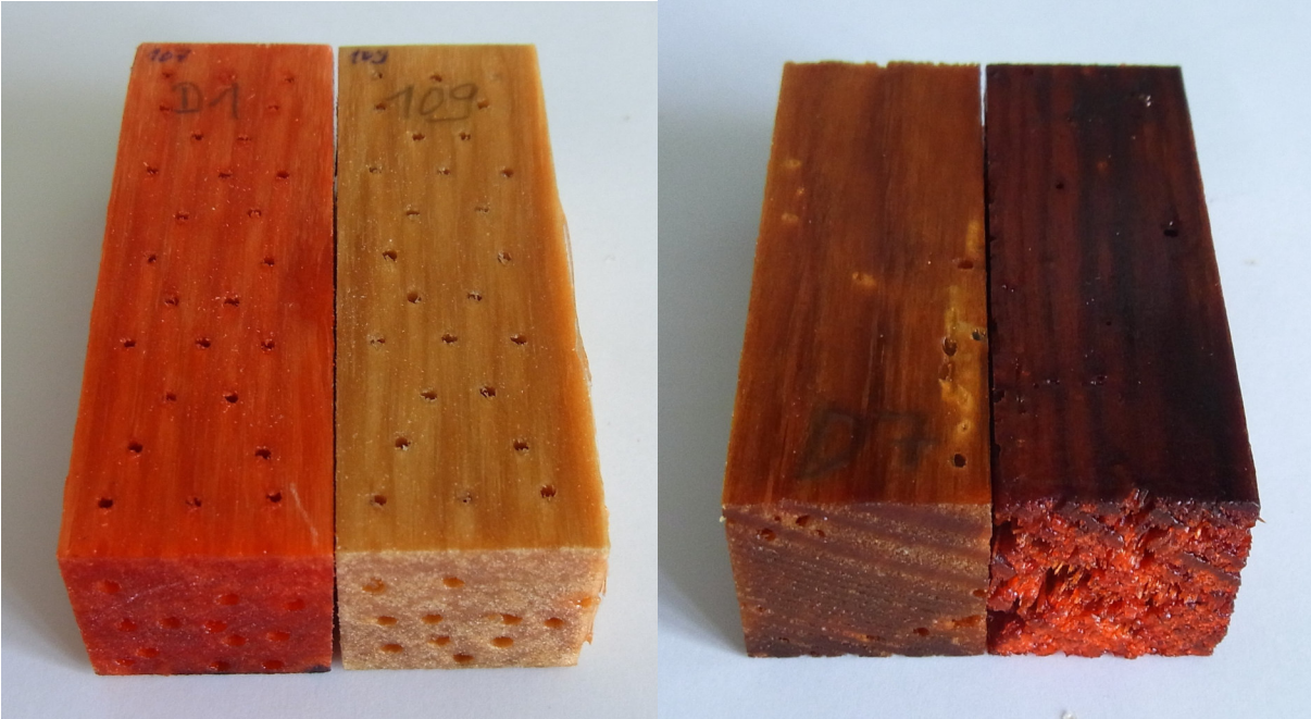
Abb. 108: Gefestigte Prüfkörper mit und ohne Farbstoff im Festigungsmittel (li. Linde, re. Kiefer)
