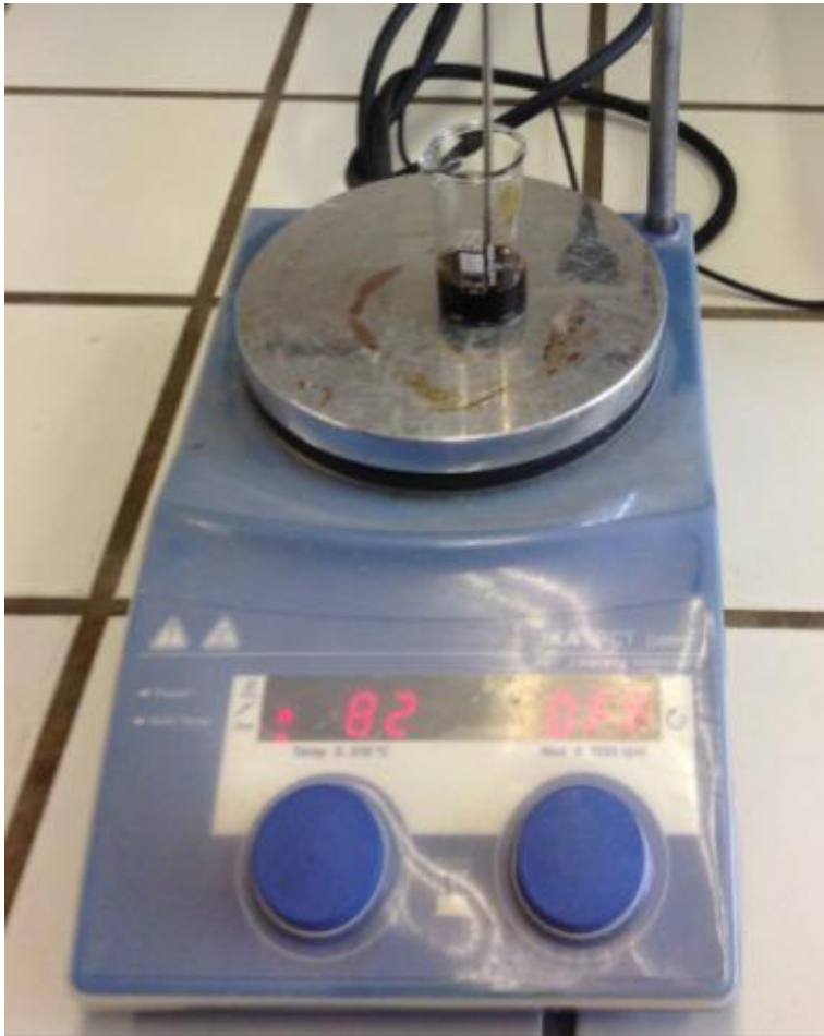
Abb. 76: Verdampfen des 1,3-Dioxolan (Siedepunkt: 75 °C) aus dem Öl-Extrakt bei 80 °C
