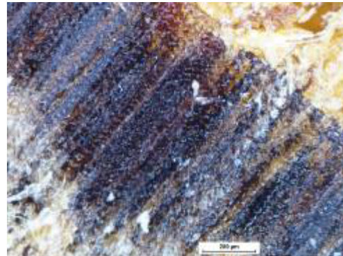
Abb. 120: Querschnitt P3 (30%) Öl in den Fasern erkennbar, äußerst gering ausgetreten; M 100:1
