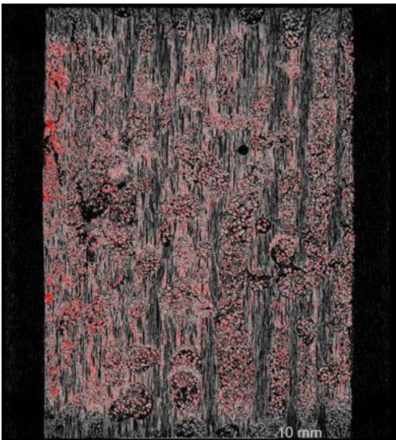
Abb. 36: verolte Lindenholzprobe, Längsschnitt, Defektanalyse
