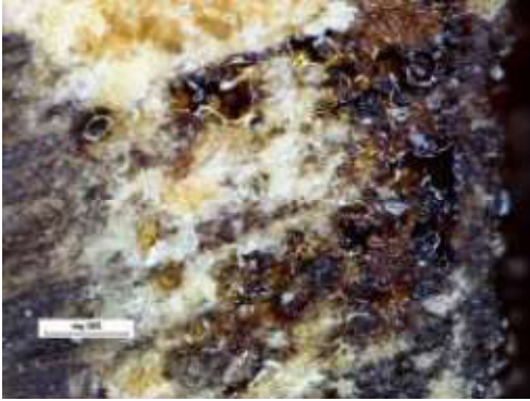
Abb. 121: Querschnitt P5 Kiefer 10 % Öl + Degalan in den Fasern erkennbar, gering ausgetreten; M 100:1
