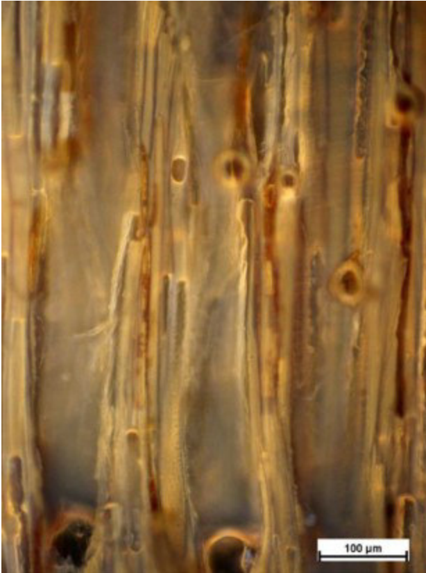
Abb. 21: verölzte Holzprobe, Fasern, Holzstrahlen und teilweise Gefäße mit Öleinlagerungen Tangentialschnitt, UV-Licht (200fach)
