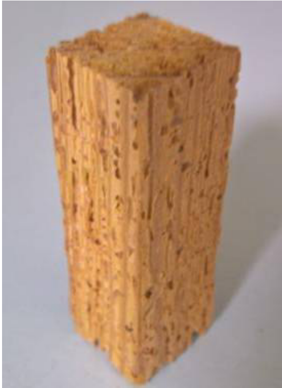
Abb. 68: durch Holzschädlinge degradierte Kiefernholzprüfkörper
