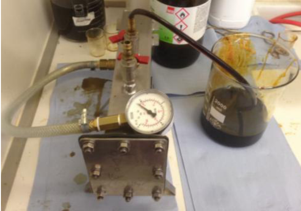
Abb. 78: Tränkungsautoklav, Einbringen des Öl-Extrakts als Tränkungsmedium
