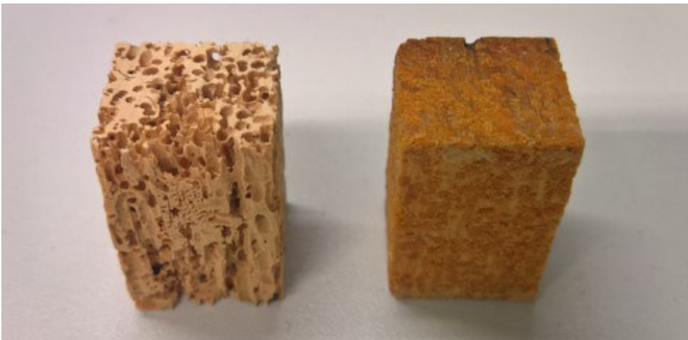
Abb. 34: verölte (re.) und entölte (li.) Lindenholzproben der Führungsbretter des Heiligen Grabes aus dem Zwickauer Dom
