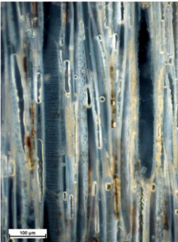
Abb. 22: entölzte Holzprobe, vereinzelt in Fasern- und Längsparenchymzellen Ölbestandteile vorhanden, Tangentialschnitt, UV-Licht (200fach)
