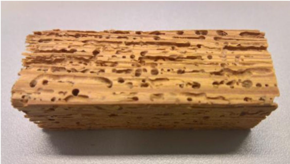
Abb. 74: durch Holzschädlinge degradierter Kiefernholzprüfkörper
