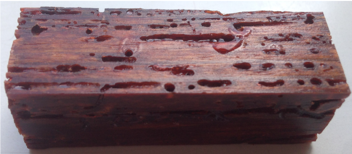
Abb. 112: Überschüssiges Festigungsmittel auf der Oberfläche eines Prüfkörpers
