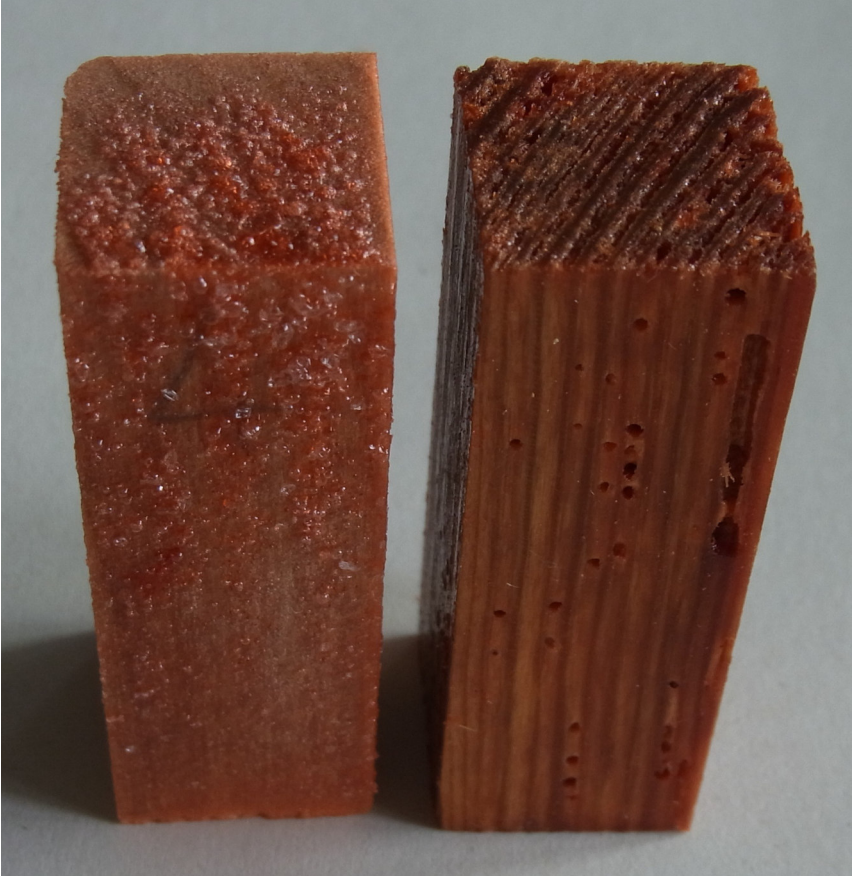
Abb. 105: Blasenbildung des Degalans P28 auf der Oberfläche
