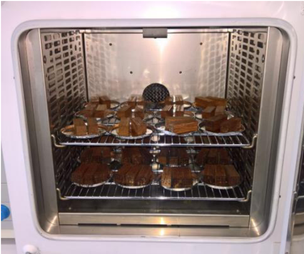
Abb. 80: Holzprüfkörper im Wärmeschrank
