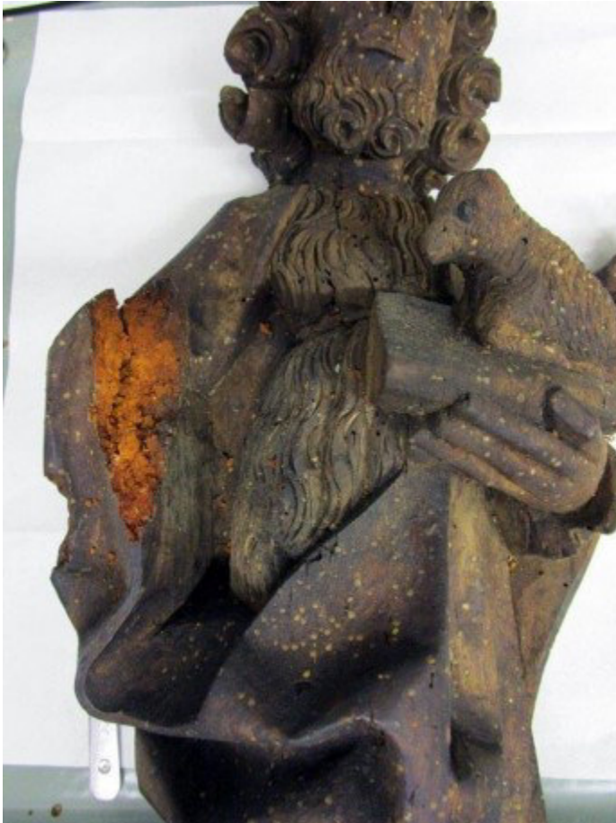
Abb. 16: nach der Entölung mit Fehlstelle, defekte Holzstruktur unter der Oberfläche, Johannes HI. Grab Dom Zwickau
