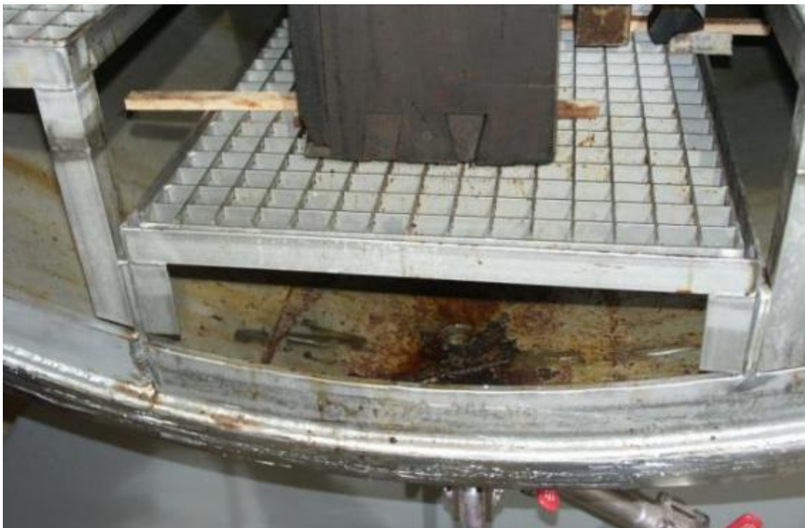
Abb. 66: Großer Kessel, Entölungautoklav, Restaurierungsatelier Püschner, Detail
