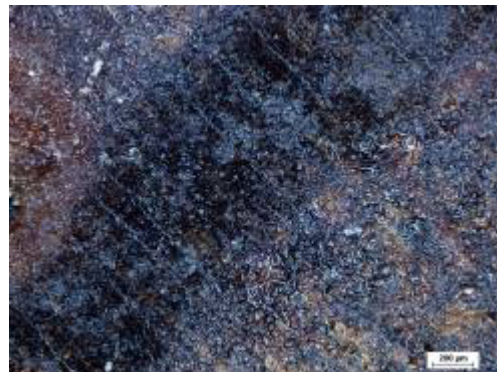
Abb. 124: Querschnitt P10 Kiefer 10 % Öl, Öl in den Zellen erkennbar, gering ausgetreten M 100:1
