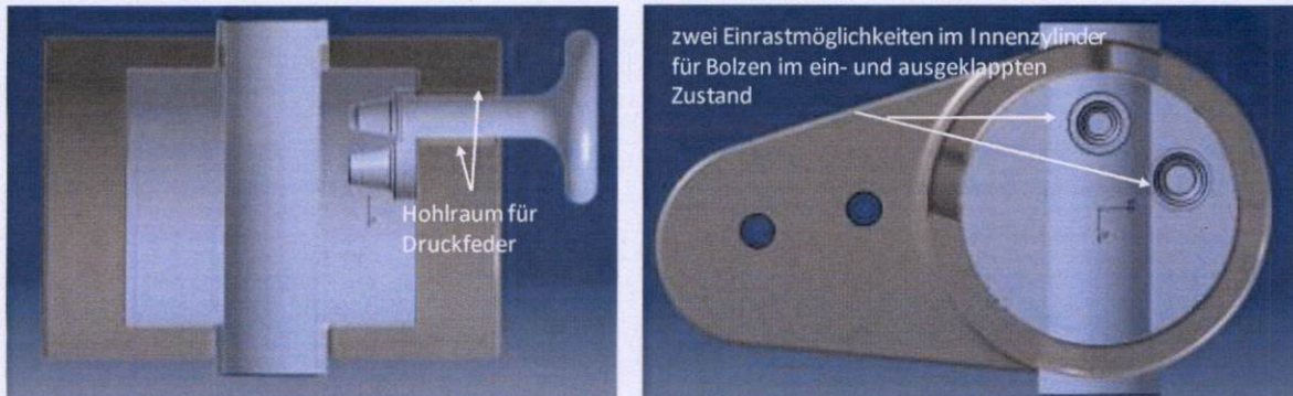
Abbildung 13: links: Schnitt durch Sperrbolzen und Bereich der einzulegenden Feder; rechts: seitlicher Schnitt der Einrastmöglichkeiten des Bolzens
