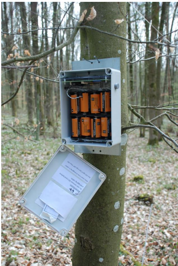
Abb. 19: Autonomer Audiorekorder zur Aufzeichnung von Naturgeräuschen in geöffnetem Zustand.
