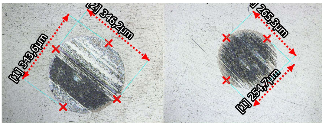
Abbildung 3. Repräsentative Mikroskopaufnahmen von TPPT (links) und Irgalube L63® (rechts) bei äquivalenten Stoffmengen. Testkonditionen: 150 N, 60 min, 1450 U/min, 25°C, 100Cr6 G10 KGM Kugeln.
