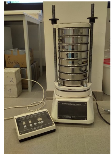
Abb.6.4.1.1: verwendete Analysensiebmaschine HAVER EML 200
