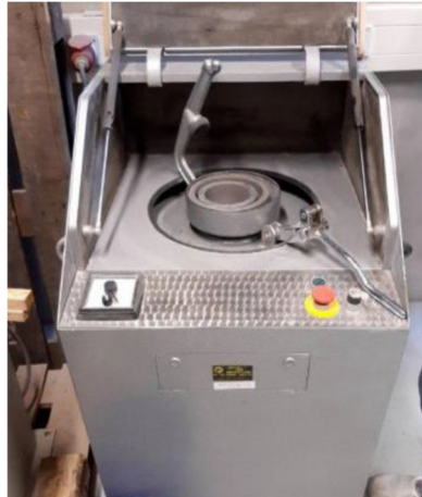
Abb.4.1.1.3: Scheibenschwingmühle RS von Retsch
