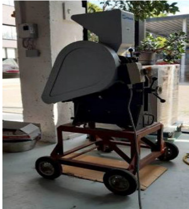
Abb. 4.1.1.1: Backenbrechermühle Retsch BB 100
