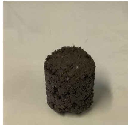
Abb.5.6.2: Der Zustand der Rezyklatprobe T3.4-M (Mischungsverhältnis 1:3:0,8)
