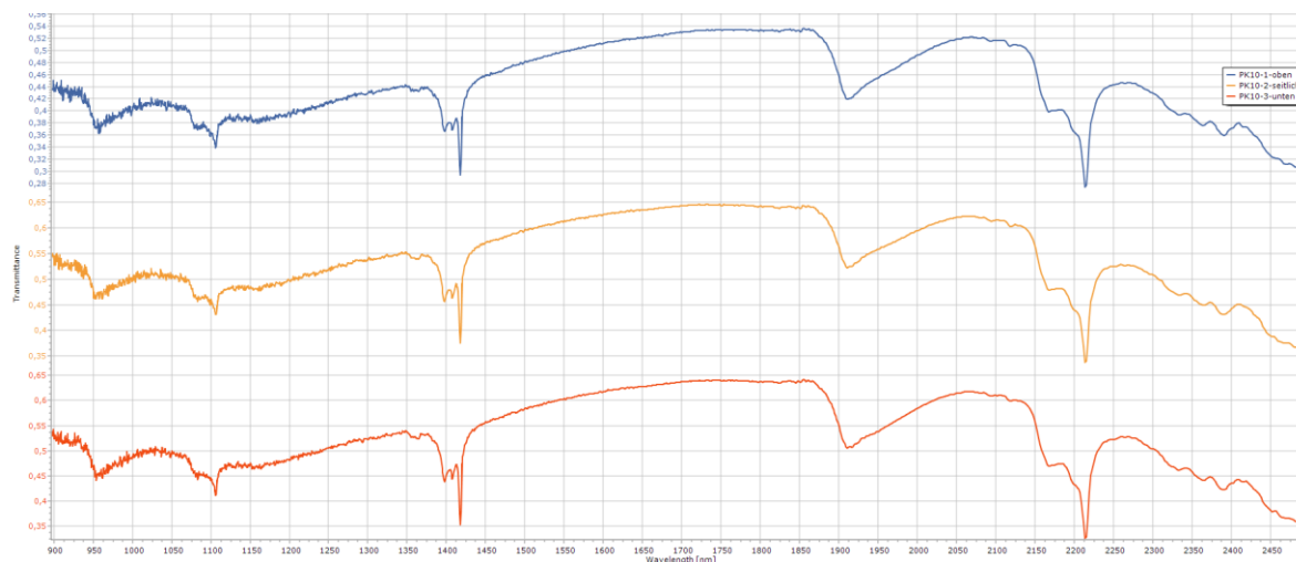
Abb. A68: Nah-Infrarot-Messungen am Probekörper PK10, Cottaer Sandstein, unbelastet
