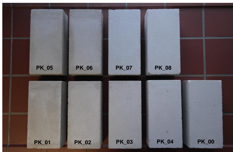
Abb. 4: Handelsüblicher „Kalksandstein“ mit verschiedenen Salzbelastungen; die angegebenen Gehalte entsprechen den Konzentrationen der jeweiligen Anionen; \text{MgSO}_4 \cdot 7\text{H}_2\text{O} : PK_01: >2% Sulfat, PK_02: 1,5% Sulfat, PK_03: 1% Sulfat, PK_04: 0,5% Sulfat; \text{KNO}_3 : PK_05: 1% Nitrat, PK_06: 0,5% Nitrat, PK_07: 0,3% Nitrat, PK_08: 0,1% Nitrat, PK_00: unbelastet
