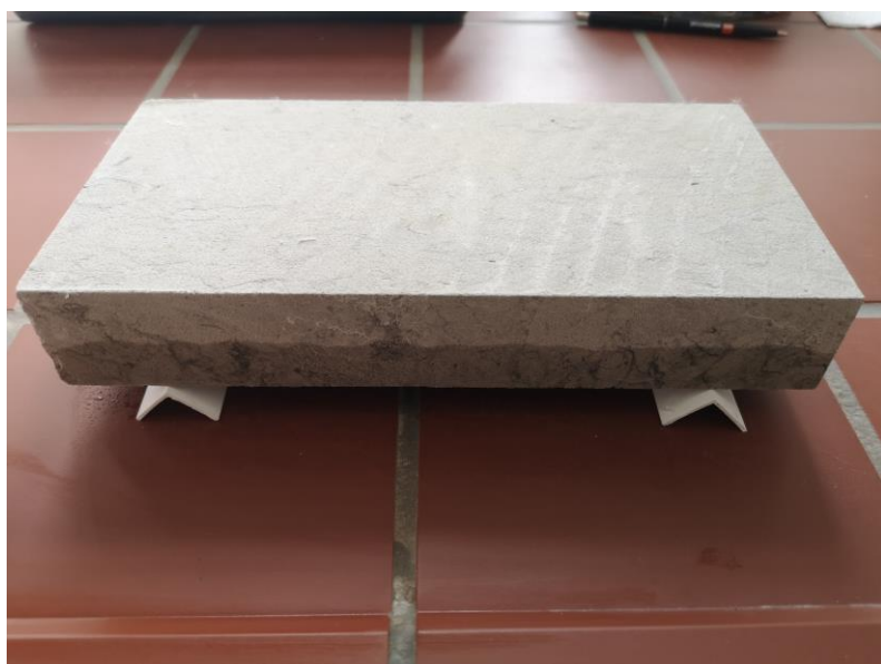
Abb. 3: Mit Salzlösung durch kapillaren Aufstieg befeuchteter Probekörper aus Cottaer Sandstein
