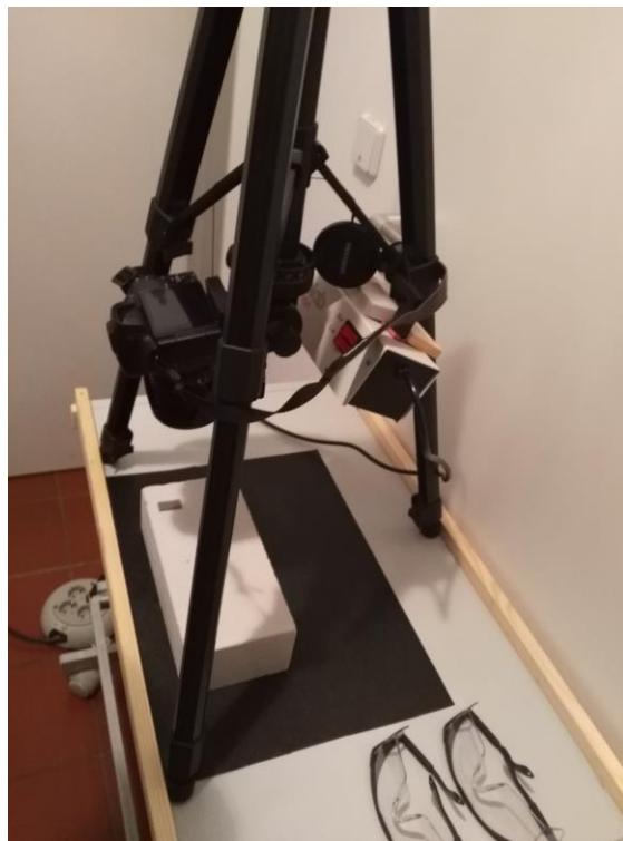
Abb. 18 u. 19: Aufbau zur Aufnahme von UV-Langzeitfotos; zur Vermeidung störender Lumineszens aus der Umgebung des Probekörpers wird statt einer Papierunterlage eine schwarze Kunststoffunterlage verwendet
