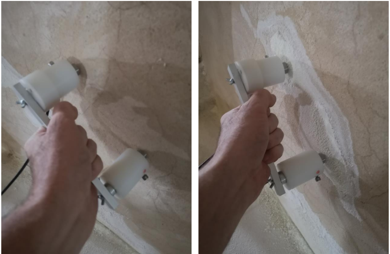
Abb. 58: Ermsleben, Konradsburg, Krypta: Aufsetzen des Ultraschallmesskopfpaares in einem oberflächlich stark und weniger stark salzbelasteten Bereich
