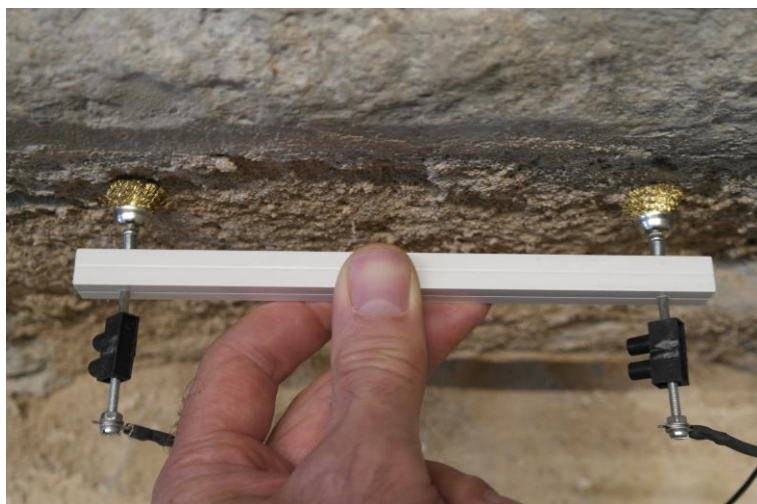
Abb. 42: Messung der Leitfähigkeit einer salzbelasteten Oberfläche im Graben unterhalb der Westwand des Heiligen Grabes
