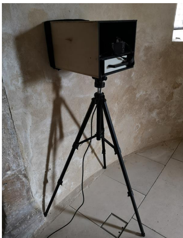
Abb. 53: Ermsleben, Konradsburg, Krypta: Vorrichtung zur langzeitfotografischen Erfassung der UV-Lumineszenz von salzbelasteten Oberflächen. Im unteren Teil befindet sich die UV-Lampe, darüber ist die Kamera positioniert. Zur Erstellung der Aufnahme wird die rückseitige Öffnung lichtdicht verschlossen.
