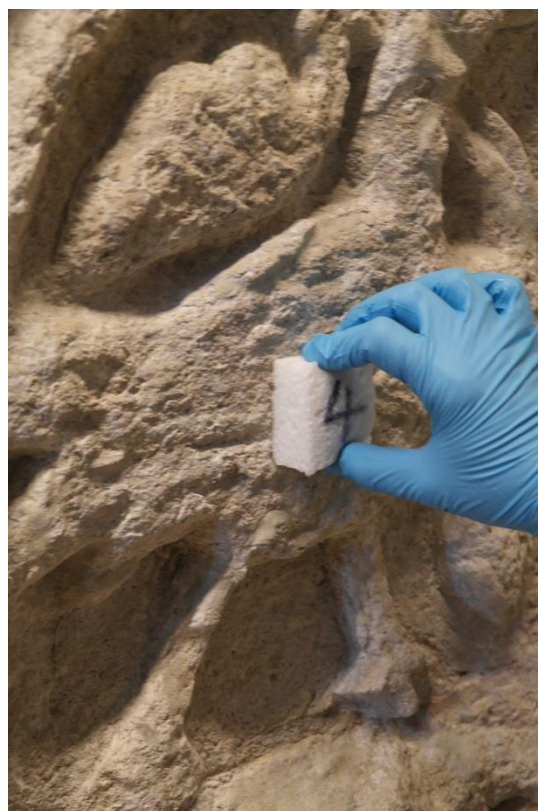
Abb. A16: Probenahmepunkt SK04, Beprobung der Ornamentik der Westwand des Heiligen Grabes
