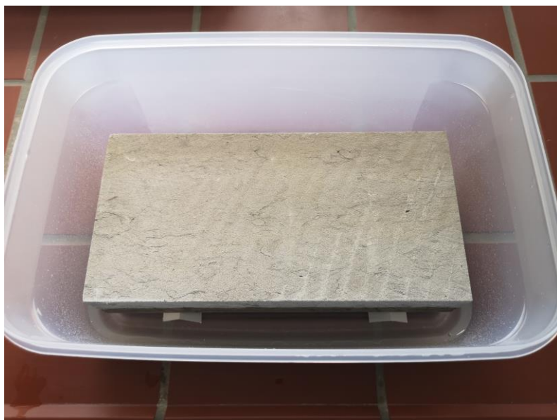
Abb. 2: Behälter zur Herstellung definiert salzbelasteter Probekörper mit Salzlösung und Probekörper aus Cottaer Sandstein
