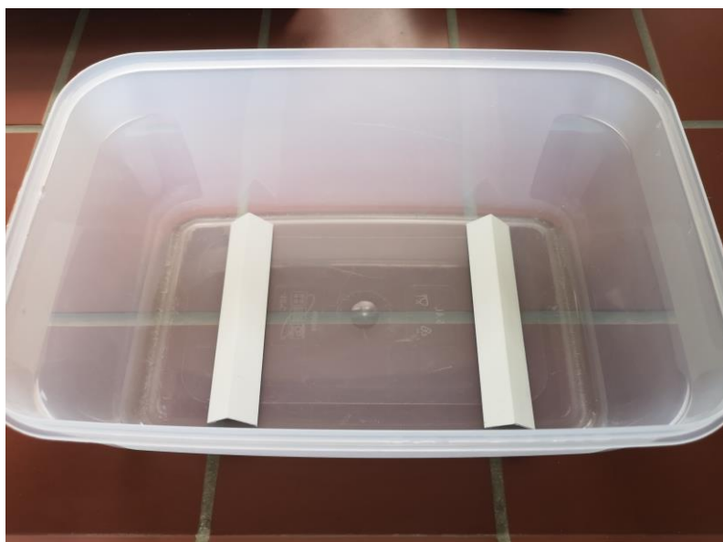
Abb. 1: Behälter zur Herstellung definiert salzbelasteter Probekörper mit Stegen zur Auflage der Probekörper
