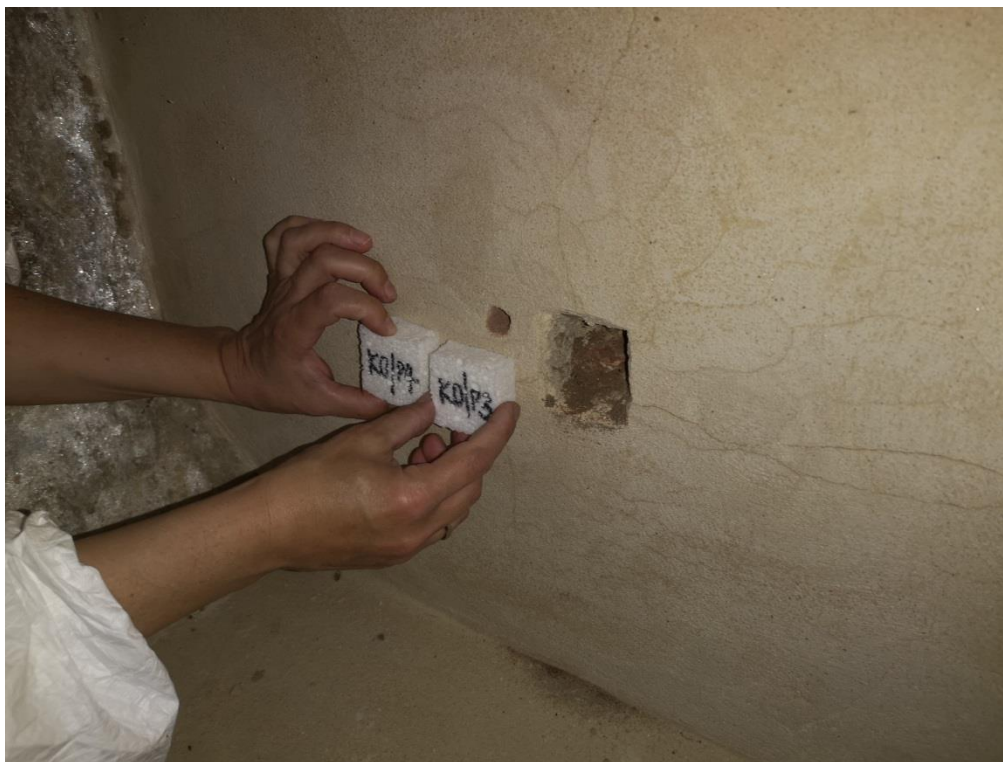
Abb. A33: Ermsleben, Konradsburg, Krypta: Schwammkompressen zur Beprobung salzbelasteter Oberflächen (Probenahmepunkt 2, Westwand, Mitte)
