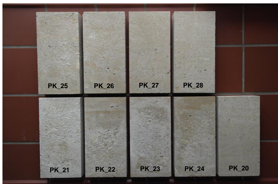
Abb. 6: Freyburger Kalkstein mit verschiedenen Salzbelastungen; die angegebenen Gehalte entsprechen den Konzentrationen der jeweiligen Anionen; \text{MgSO}_4 \cdot 7\text{H}_2\text{O} : PK_21: >2% Sulfat, PK_22: 1,5% Sulfat, PK_23: 1% Sulfat, PK_24: 0,5% Sulfat; \text{KNO}_3 : PK_25: 1% Nitrat, PK_26: 0,5% Nitrat, PK_27: 0,3% Nitrat, PK_28: 0,1% Nitrat, PK_20: unbelastet
