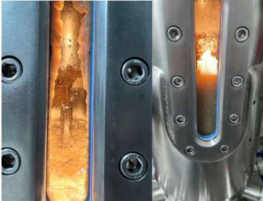
Abbildung 43: Schaumbildung im 30 l-Reaktor. Links sind Luftzufuhr und Rührwerk ausgeschaltet. Rechts sind beide in Betrieb.
