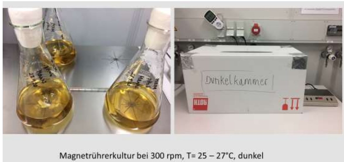
Abbildung 8: links: Vorkultur auf Magnetrührplatten; rechts: DIY-Dunkelkammer
