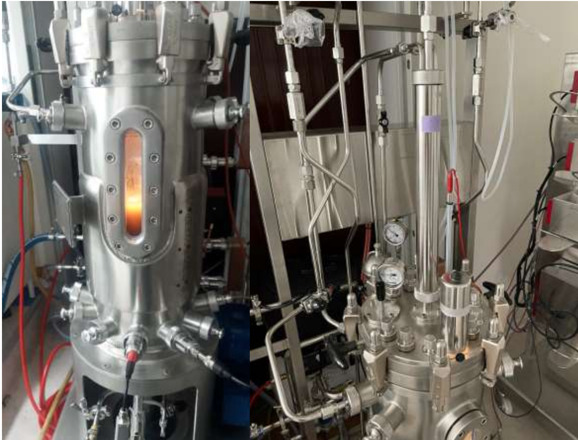
Abbildung 42: links der Behälter des 30 l-Reaktors (vorne) - belichtete Schaufenster, Anschlüsse der pH und pO 2 Sonden; rechts die obere Hälfte des 30 l-Reaktors - Abluft, Ventile, Druckmessung, Anschluss der Sonde für Erkennung der Schaumhöhe, Peristaltikpumpen.
