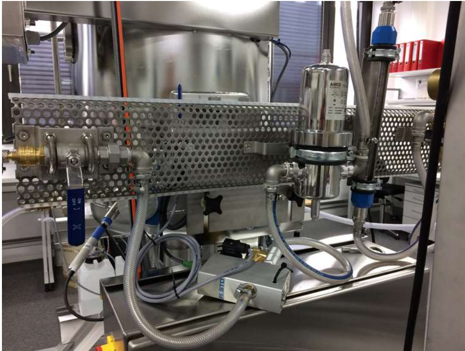
Abbildung 24: Zuluftstrecke über Filtereinrichtung und Lufzufuhrregulator.
