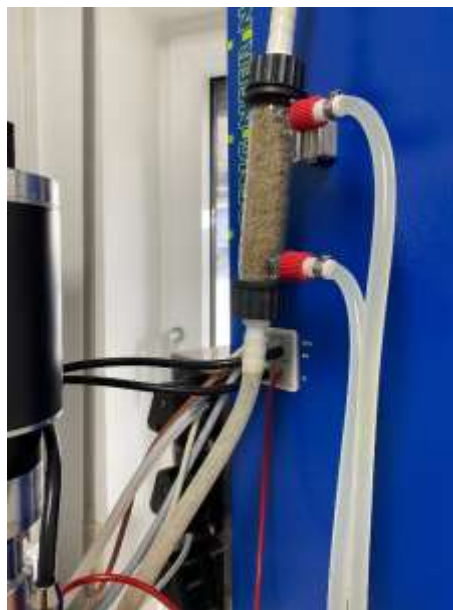
Abbildung 39: Ein Fermentationslauf im 5 l-Reaktor ohne Antischaummittel führte zu Myzelwachstum in der Peripherie.
