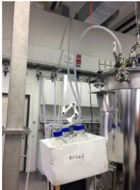
Abbildung 29: Abluftstrecke im Eisbad.
