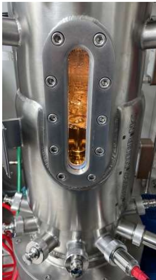
Abbildung 48: 30 l-Fermenter befüllt mit LB-Medium nach 10 Tagen Standzeit und Dampfsterilisation des Ablassventils
