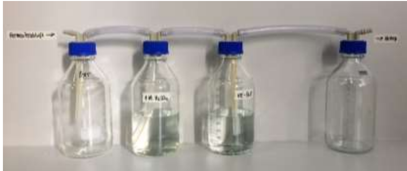
Abbildung 28: Abluftstrecke durch Flaschen, die wie folgt befüllt waren: 1 leer, 2 1 mol/l H_2SO_4 3 VE-Wasser, 4 leer.
