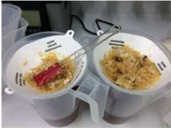
a) Einmalsieb, Maschenweite 260 \mu\text{m}
