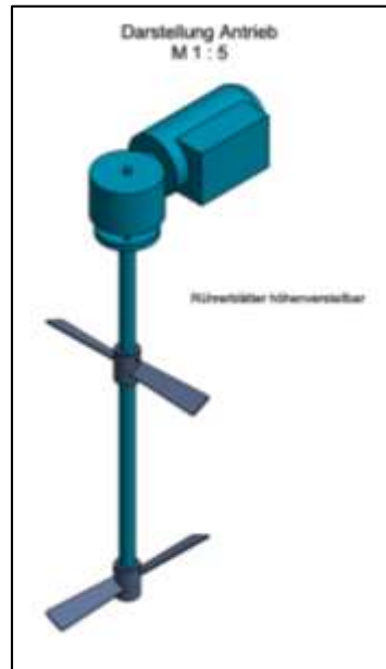
Abbildung 22: Technische Zeichnung der Rührwelle mit Rührblättern und Antrieb
