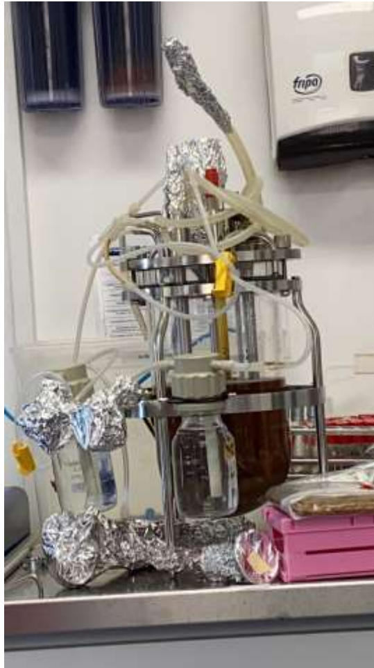
Abbildung 36: 5 l-Reaktor beim Abkühlen nach der Sterilisierung im Autoklaven.
