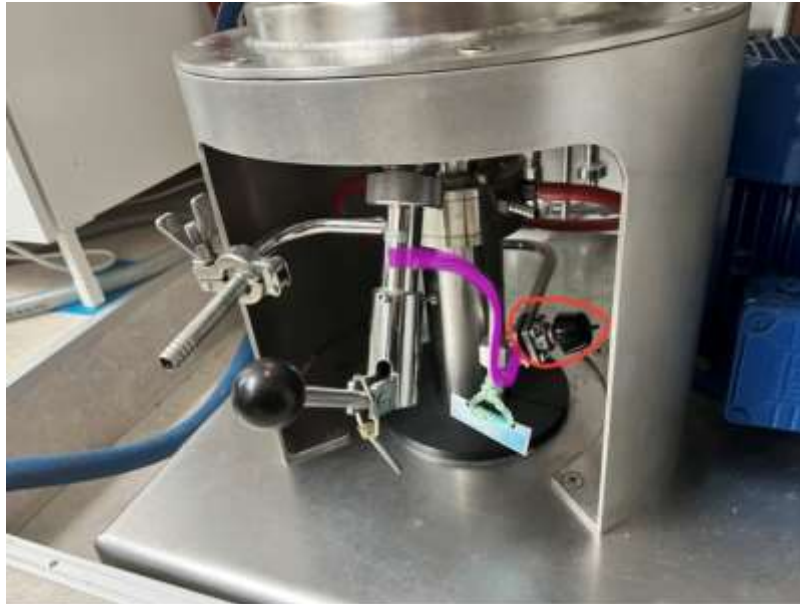
Abbildung 47: Ablassventil rot gekennzeichnet. Kontaminationsquelle ist Lila markiert.
