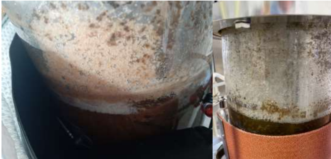
Abbildung 38: Schaumbildung während des Fermentationlaufs.
