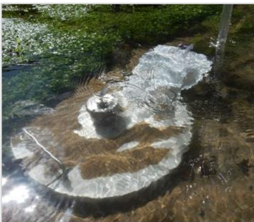
Abbildung 4: Seepage-Messgerät zur Ermittlung des Leakage-Koeffizienten im Gewässer (unten) und Messung der Druckhöhe im Grundwasser unter der Gewässer- sohle (oben)
