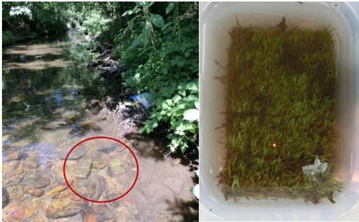
Abb. 13: Sedimentmatten aus Kunstrasen zur Ermittlung der transportierten Feinsedimentmenge.
