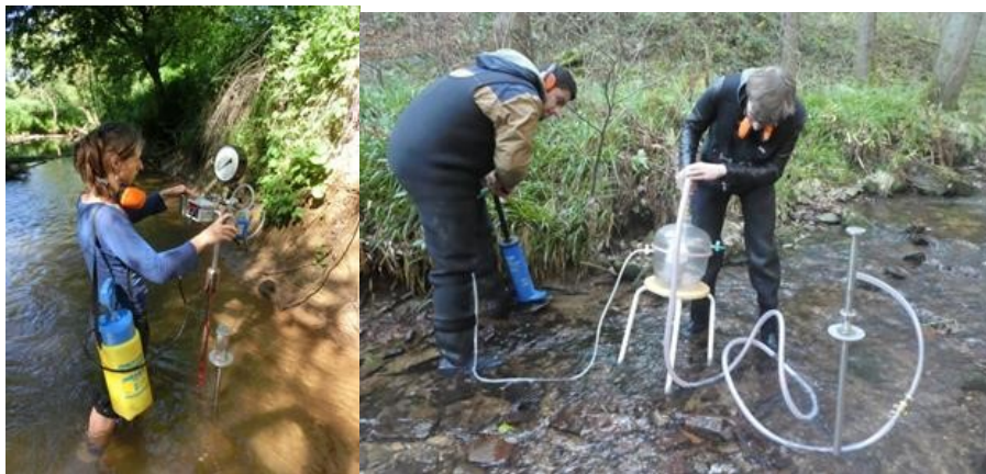
Abb. 11: links) Kolmometermessung; rechts) Entnahme der Interstitialprobe mittels Schlagrohrmethode und Exsikkatorpumpe mit Studierenden.
